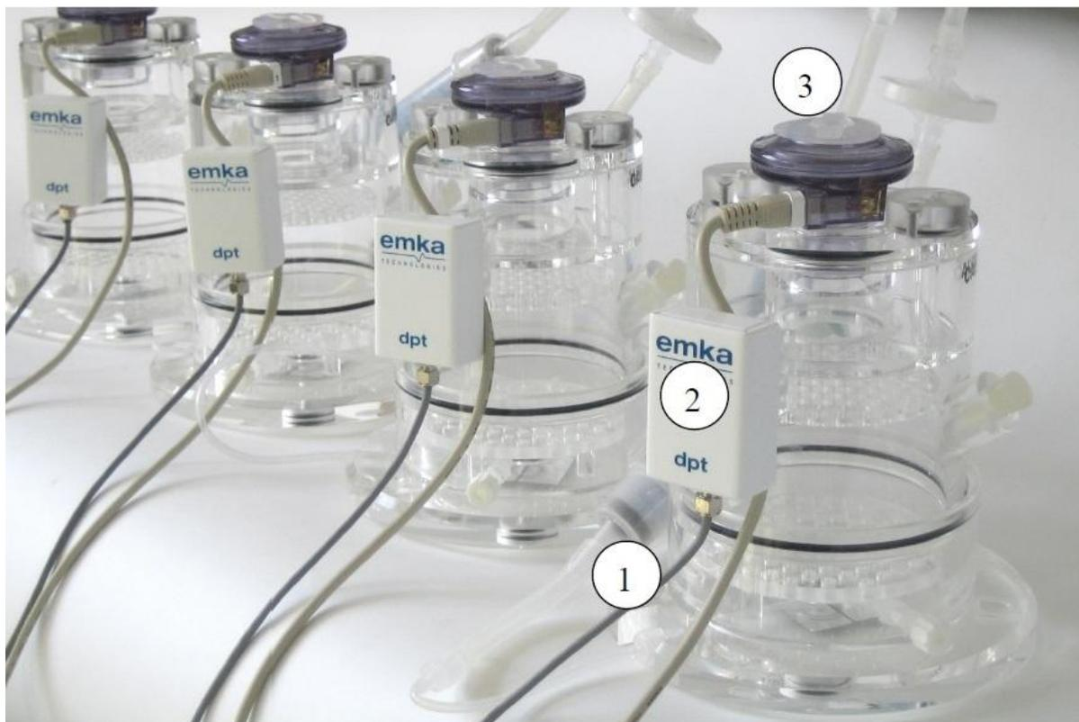
**Figure 20 : photographie des chambres du pléthysmographe.**
