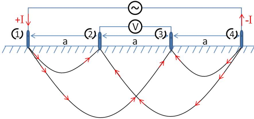
FIGURE 2.3.6 – Couplage entre électrodes de Wenner.
