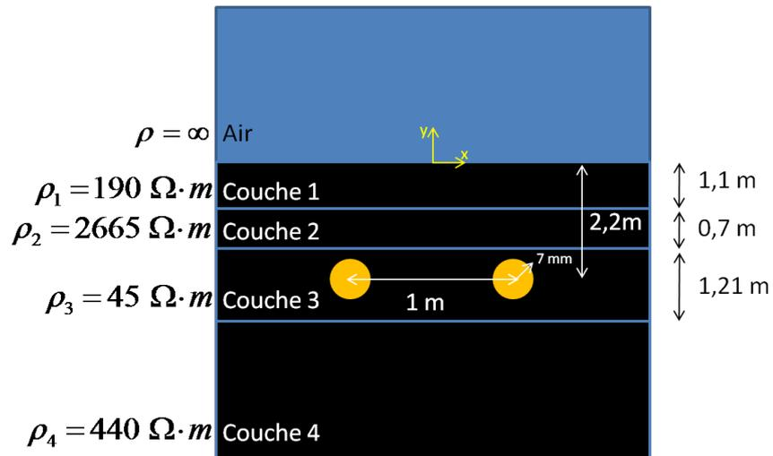
FIGURE 3.6.4 – Configuration des conducteurs nus enterrés aux Mollettes.
