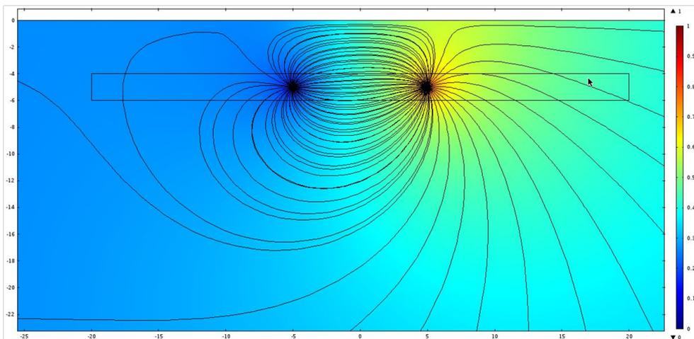
FIGURE 3.2.20 – Échange de courant entre deux conducteurs enterrés
