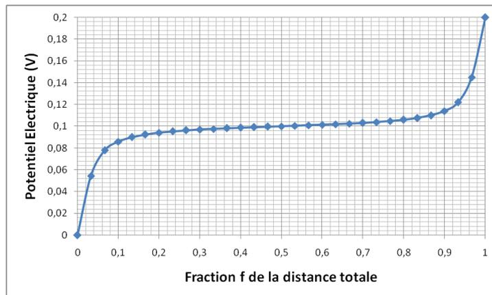
FIGURE C.2 – Différence de potentiel entre les électrodes 1 et 2.
