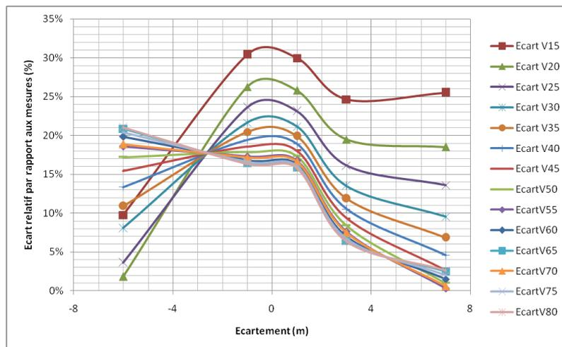
FIGURE 3.6.8 – Écart relatif entre le potentiel calculé et le potentiel mesuré, pour plusieurs longueurs de conducteurs simulés différentes.
