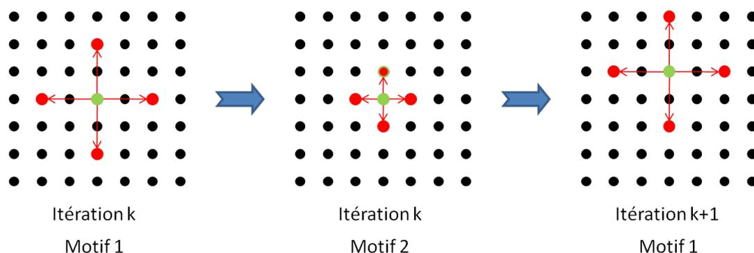
FIGURE 2.3.3 – Schéma d'évolution de l'algorithme d'optimisation pattern search.
