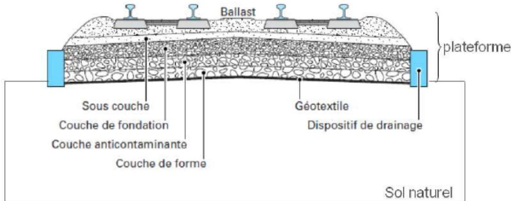
FIGURE 1.1.4 – Composition de la plateforme ferroviaire [1].
