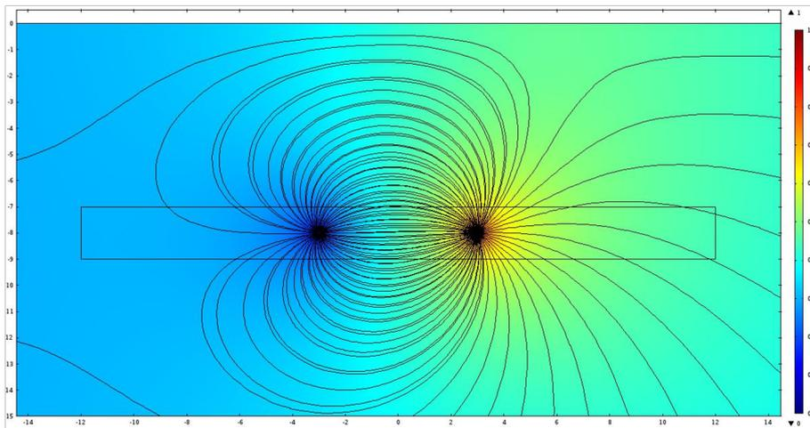
FIGURE 3.2.17 – Échange de courant entre deux conducteurs enterrés.
