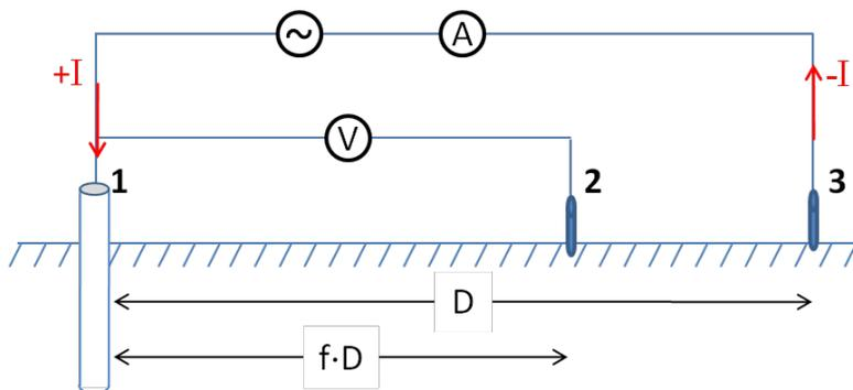
FIGURE C.1 – Disposition des électrodes pour la méthode des 62%.
