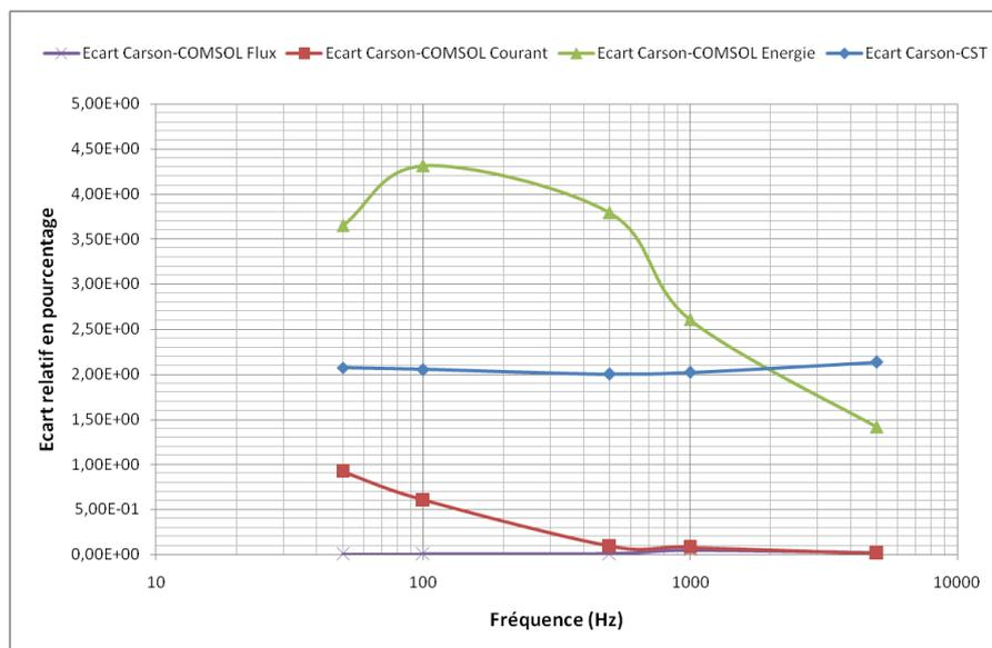
FIGURE 3.2.13 – Écart relatif de l'inductance mutuelle en fonction de la fréquence du courant. Les méthodes par éléments finis sont comparées à la méthode analytique de Carson.
