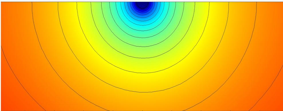
FIGURE 1.2.1 – Lignes équipotentielles pour l'injection de courant électrique par une prise de terre hémisphérique métallique dans un sol homogène
