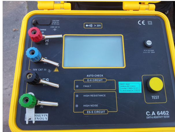
FIGURE 2.4.4 – Contrôleur de terre et de résistivité de la marque Chauvin Arnoux, modèle C.A. 6462, utilisé pour les mesures de résistivités apparentes de sol par la méthode de Wenner.
