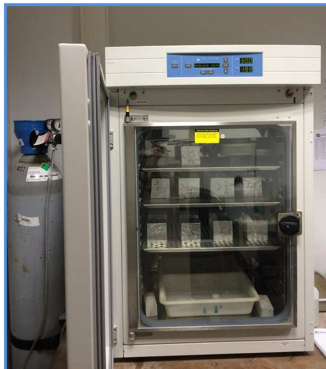
Figure 2-20: Positionnement des éprouvettes dans la cellule de carbonatation accéléré.
