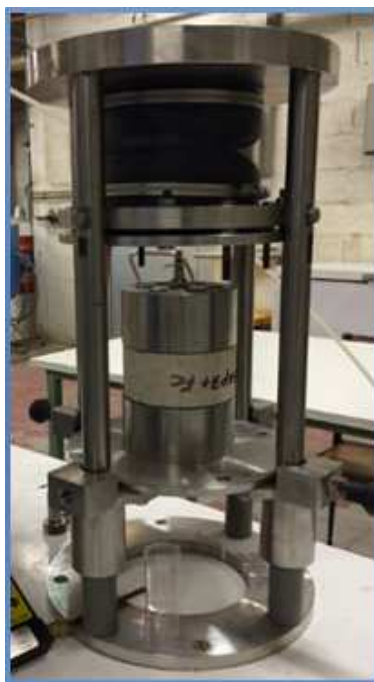
Figure 2-14: Dispositif expérimental utilisé pour la mesure de la perméabilité au gaz.
