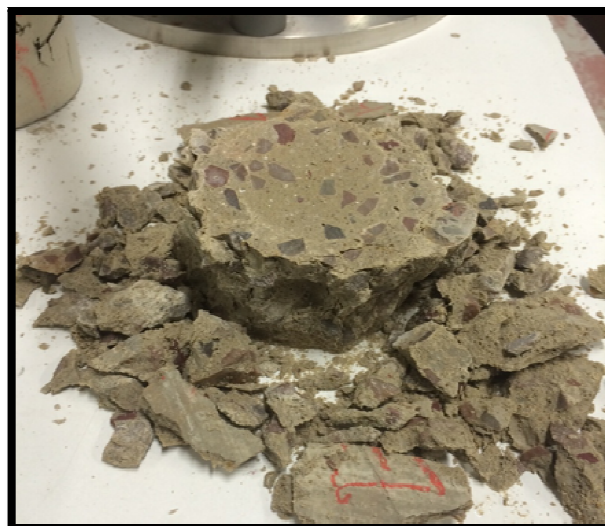
Figure 6-24: Endommagement en conditions d'encastrement de l'éprouvette, obtenu expérimentalement
