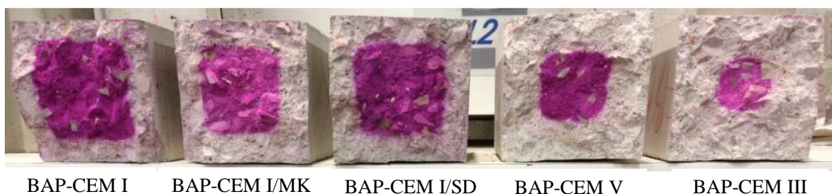
Figure 5-19: Carbonatation naturelle après 20 mois des 5 BAP étudiés.
