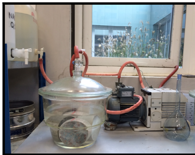
Figure 2-9: Schéma de l'essai de porosité à l'eau.
