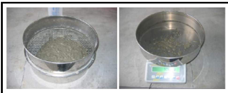
Figure 2-6: Essai de stabilité au tamis
