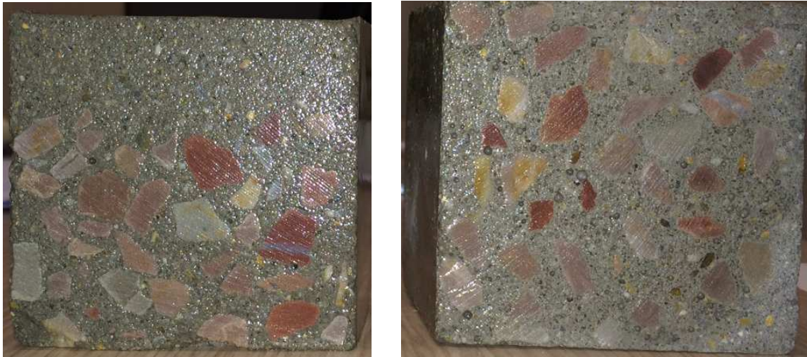
Figure 6-2: Deux échantillons de BAP de dimensions 70 \times 70 \times 280 mm avec et sans ségrégation
