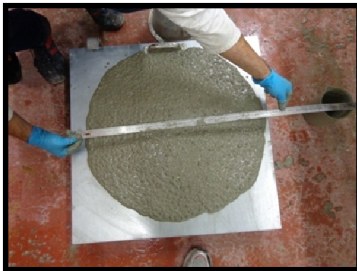
Figure 2-4: Essai d'étalement au cône (slump flow).
