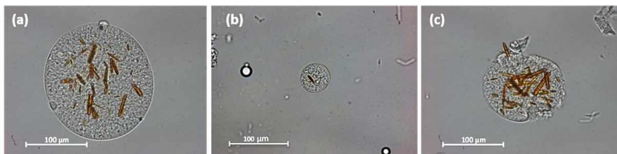
Figure.V.6. Images par microscopie optique de microparticules chargées en riboflavine: (a) préparée par agitation 900 rpm chargée avec 1% de riboflavine ; (b) préparée par ultra-turax chargée avec 0.1% riboflavine ; (c) microparticule en début de dégradation dans le milieu intestinal en présence de pancréatine.
