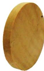
Figure II.1 : Disque de liège de 3 mm d'épaisseur et de 24 mm de diamètre.
