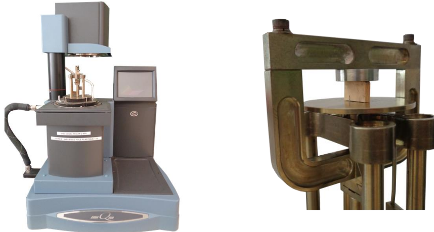
Figure II.10 : Analyseur mécanique dynamique Q800 (TA Instrument) en mode compression.
