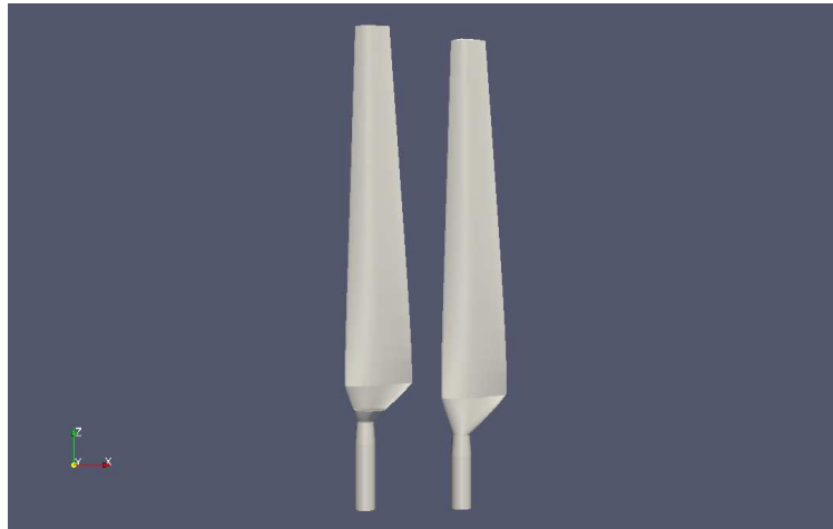
FIGURE 3.12 – La comparaison des pales avant (droite) et après (gauche) le rallongement, visualisées en image 3D.
