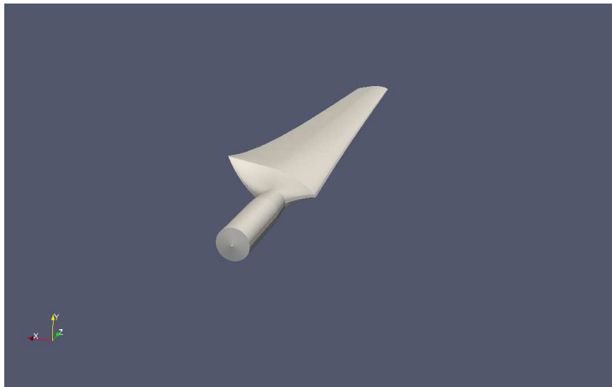
FIGURE 2.13 – Visualisation 3D de la pale utilisée dans la UAE Phase 6
