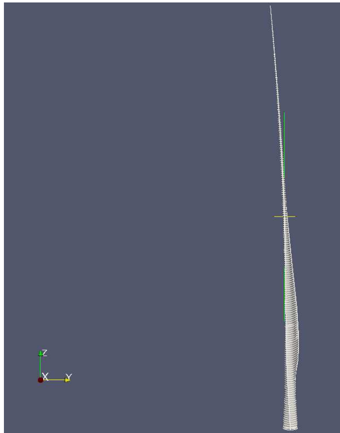
FIGURE B.2 – La cambrure d'une pale de 54m, visualisée sous Paraview.
