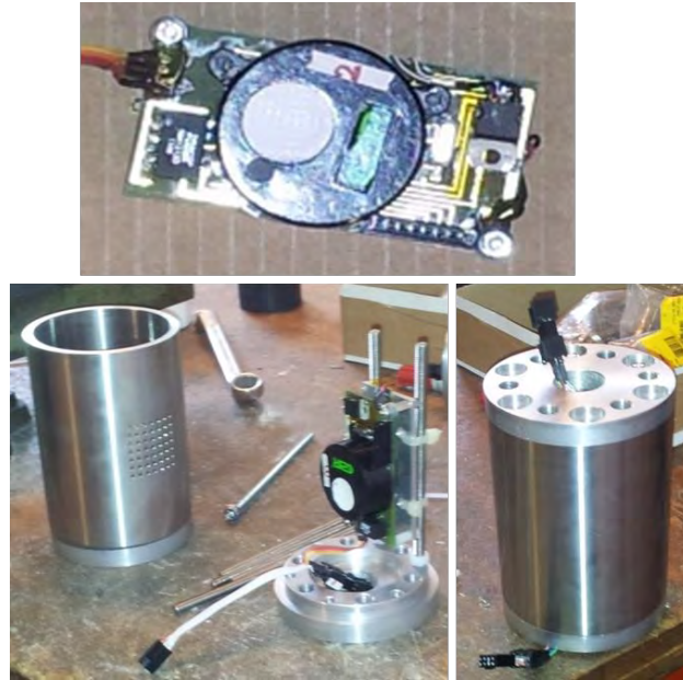
Figure 46 : Montage du module multi capteurs SILOTEST 3
