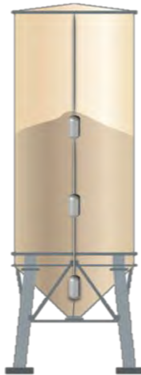
Figure 43 : Sonde SILOTEST 3 implémentée dans un silo
