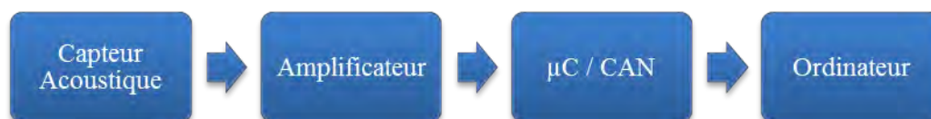
Figure 60 : Chaîne d'acquisition des signaux acoustiques
