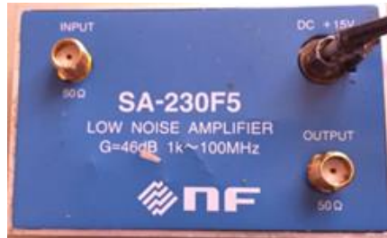
Figure 22: Amplificateur de tension faible bruit modèle SA-230F5
