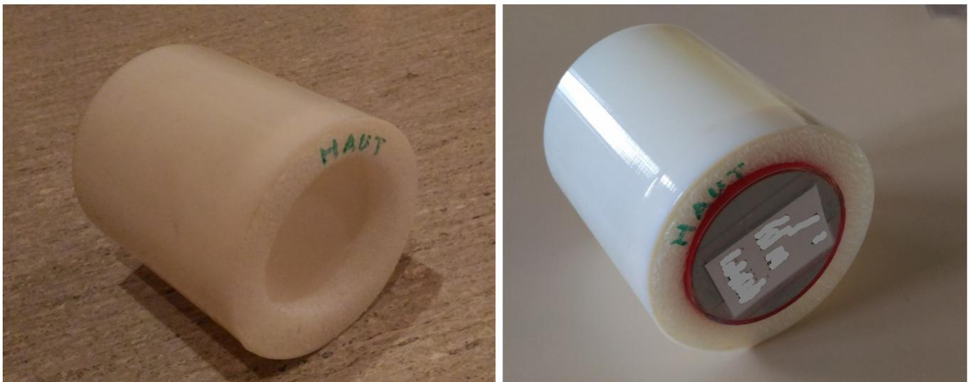
Figure 55 – Support pour la géométrie de mesure 60 mL.
