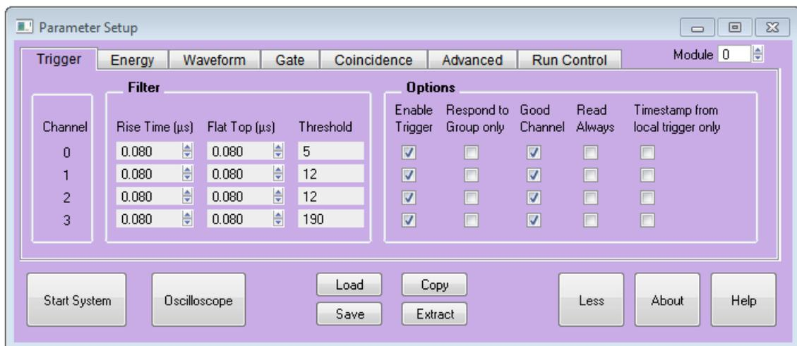
Figure 56 – Réglages des filtres rapides du Pixie-4 [XIA [51]] dans l'onglet "Trigger"
