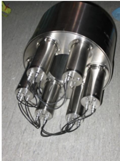
Figure 52 – Photo du scintillateur NaI (Hélène)
