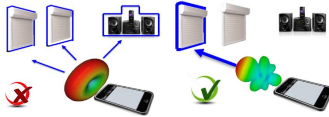
Figure 1 : Illustration d'une antenne miniature directive pour une application de RFID en environnement domestique
