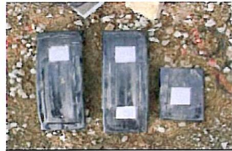
Figure II.A-2 : Coupons de tube d'acier X70 avant enfouissement.
