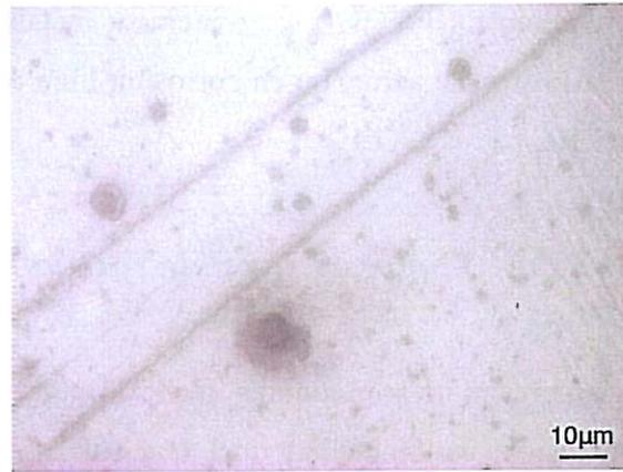
Figure I.B-2 : Photo optique in-situ de la surface de l'acier X70, après 20 heures sous PC (-925mV/ECS), dans l'eau siliceuse aérée.
