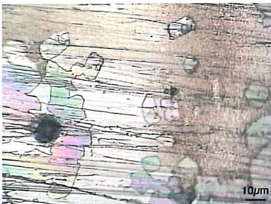
Figure II.B-12 : Photo optique *ex-situ* de la surface de l'acier X70, après 28 jours sous PC (-1125mV/ECS) dans l'eau siliceuse aérée, et après décollement de la couche formée.
