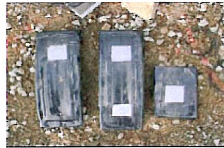
Figure II.A-2 : Coupons de tube d'acier X70 avant enfouissement.
