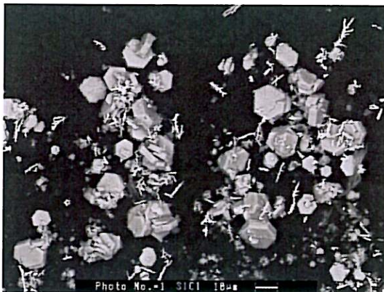
Figure V.B-4 : Image MEB de cristaux hexagonaux. Saint Saturnin – PC permanente
