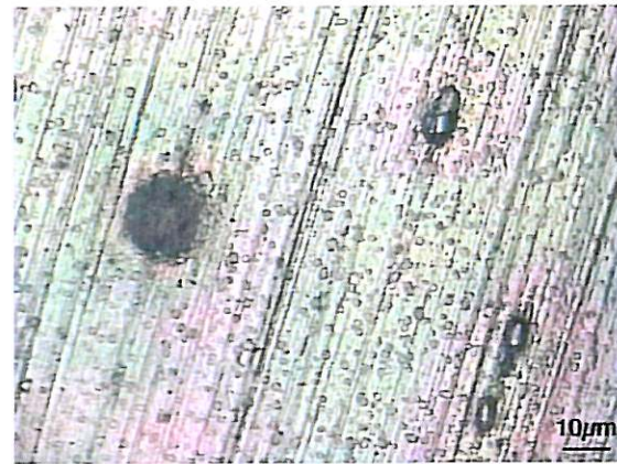
Figure II.B-11 : Photo optique ex-situ des amorces développées sur la surface de l'acier X70, après 28 jours sous PC (-1125mV/ECS) dans l'eau siliceuse aérée.
