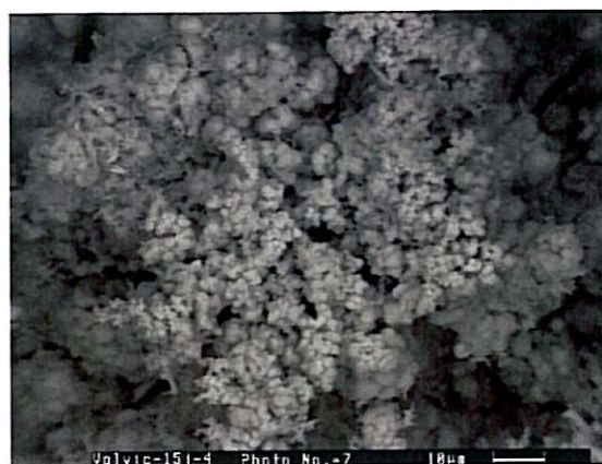
Figure II.A-2 : Image MEB de produits de corrosion particulaires formés à la surface de l'acier X70, après 14 jours de CL dans l'eau siliceuse aérée.
