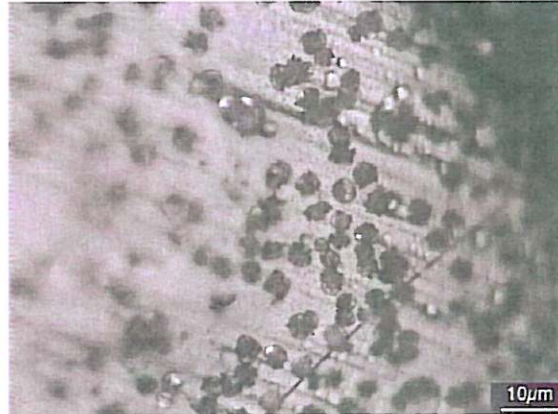
Figure IV.A-5 : Photo optique ex-situ de la face interne de la couche formée à la surface de l'acier X70 (après décollage), après 14 jours de CL et 14 jours sous PC ( -1125\text{mV/ECS} ) dans l'eau siliceuse aérée.
