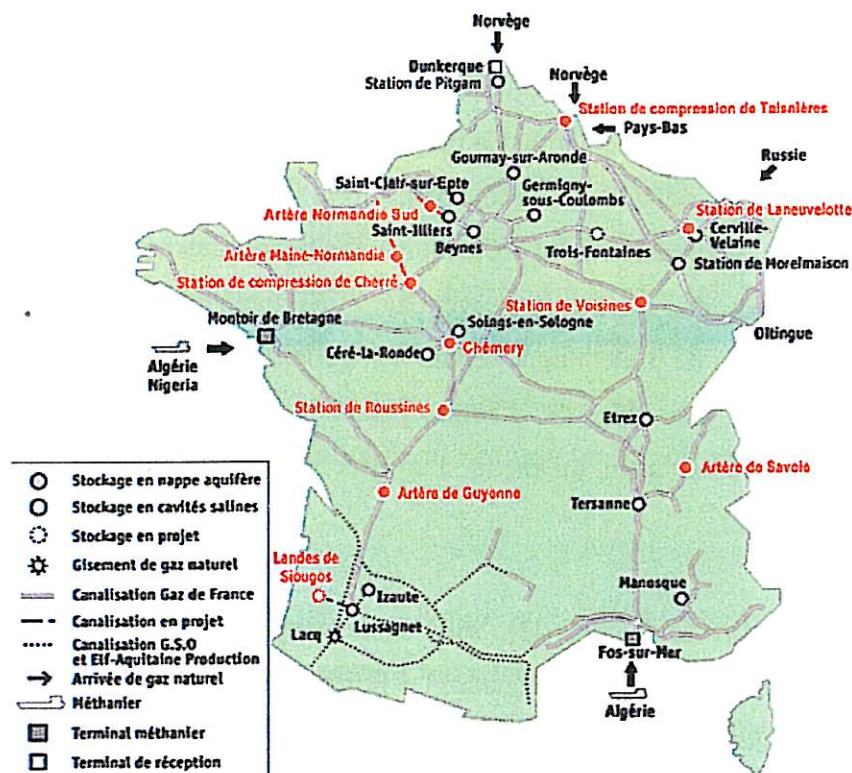
Figure I-1: Grands axes du réseau de transport de gaz en France [1].
