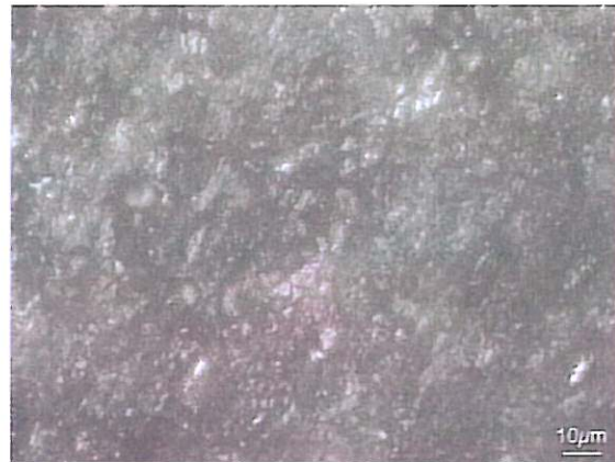
Figure III.A-7 : Photo optique ex-situ d'une zone noire à la surface de l'acier X70, après 28 jours de CL dans l'eau carbonatée désaérée saturée en calcite
