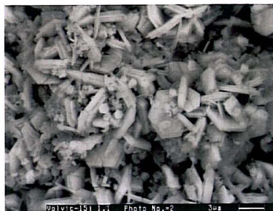
Figure II.A-4 : Image MEB de produits de corrosion hexagonaux formés à la surface de l'acier X70 après 14 jours de CL dans l'eau siliceuse aérée.
