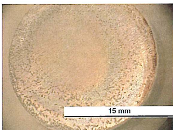
Figure II.B-6 : Photo optique de la surface de l'acier X70, après 28 jours sous PC ( -1125\text{mV/ECS} ) dans l'eau siliceuse aérée.
