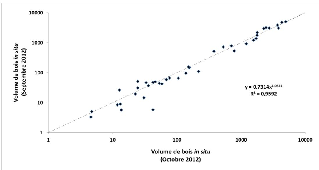
Figure 11. Estimation de la différence de mesures dans les volumes en bois accumulés dans le corridor fluvial de la rivière Saint-Jean entre septembre 2012 et octobre 2012. (La ligne pointillée représente la droite  $X=Y$ ).
