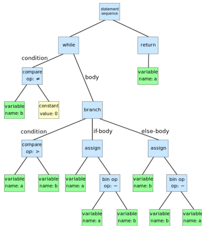
Figure. 12.2 – AST de l'algorithme d'Euclide pour le calcul de PGCD
