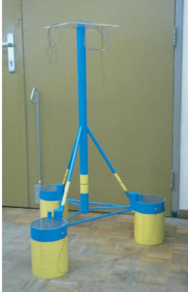
Fig. 3.3 – Modèle de structure tripode étudiée en laboratoire.
