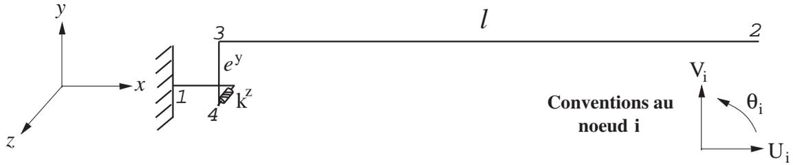
Fig. 2.4 – Modèle EFPF en 2D. Méthode des déplacements.
