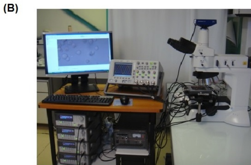
FIGURE 2.1 – (A) Dispositif expérimental employé pour l'électrorotation (les masses des générateurs sont interconnectées). (B) Plateforme servant à l'acquisition des vidéos de rotation des cellules HEK 293.
