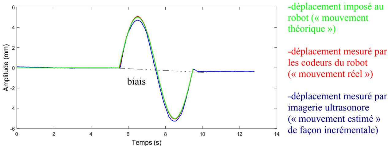
Figure 2.14 : mouvement de la sonde échographique (test 1).
