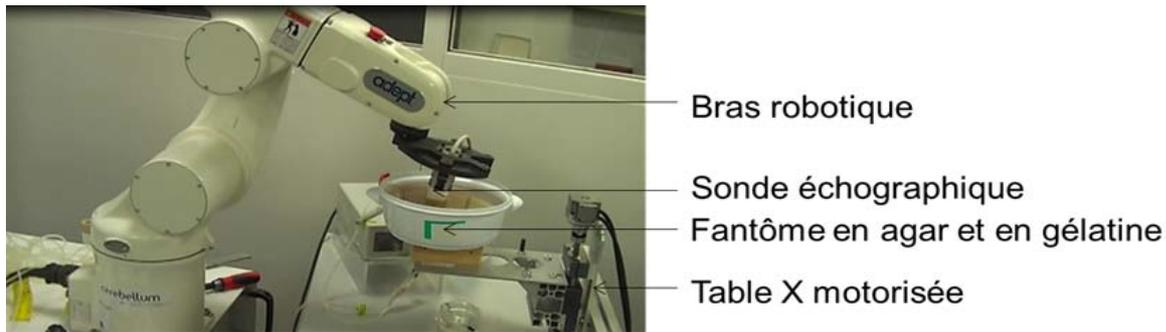
Figure 2.40 : expérience de compensation du mouvement 2D.
