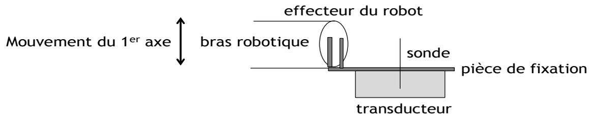
Figure 3.6 : schéma de fixation du transducteur HIFU au robot Sinters.
