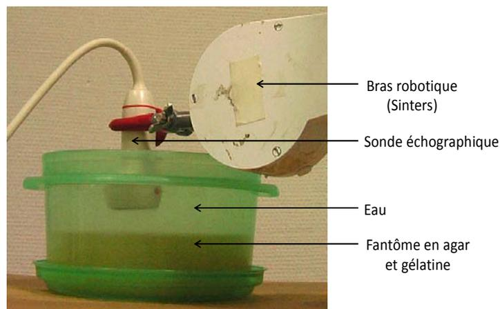
Figure 2.12 : expérience de l'estimation d'un mouvement vertical.
