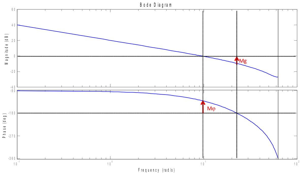
Figure 2.24 : diagrammes de Bode de la boucle ouverte du système d'asservissement
