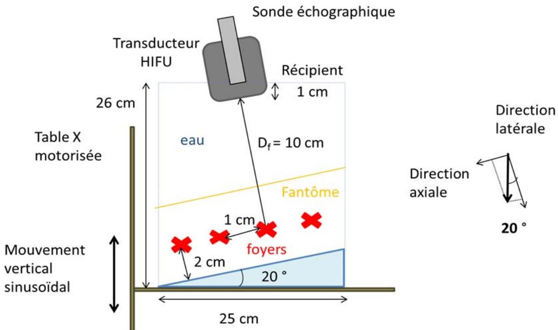
Figure 3.17 : configuration du récipient pour l'expérience de compensation 2D.
