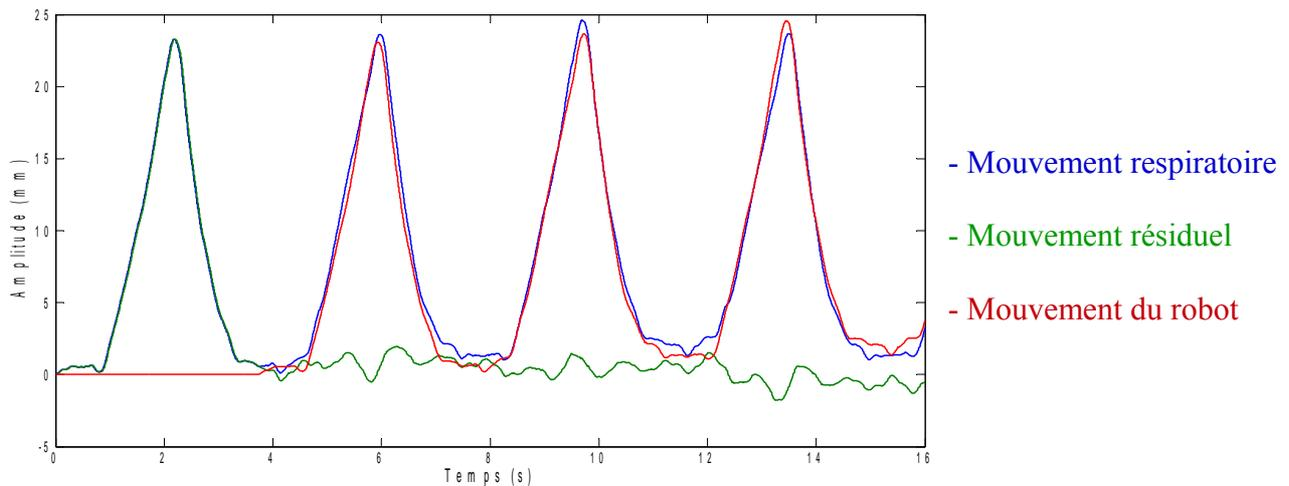
Figure 2.23 : Exemple en simulation de l'effet de la compensation par un correcteur répétitif d'un mouvement respiratoire enregistré en endoscopie.
