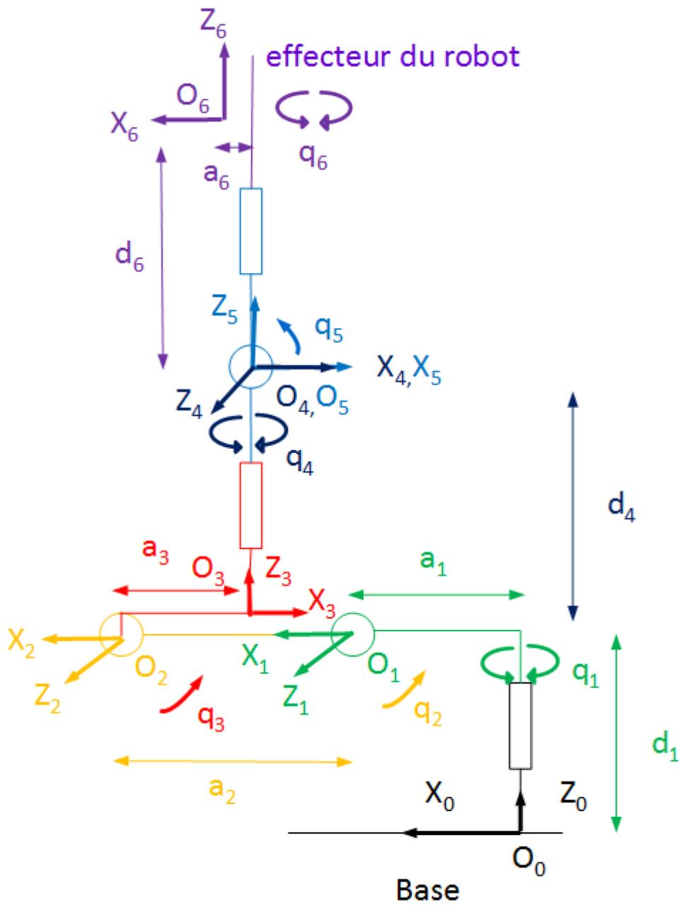
Modèle géométrique du robot :
