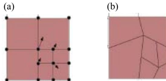
Figure 1.12 : grille initiale (a) ; grille déformée (b) [112]
