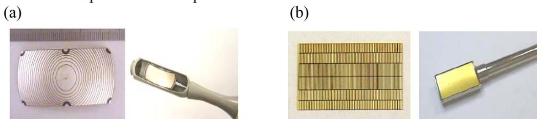
Figure 1.9 : transducteur multi-éléments annulaire (a) et cylindrique (b) [58].
