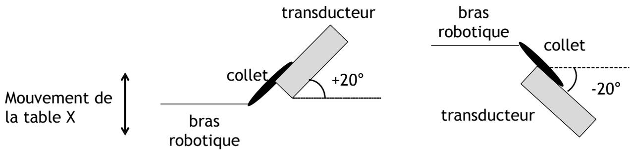
Figure 3.15 : configuration du robot Viper de ADEPT avec un transducteur orienté à +20° et -20°.
