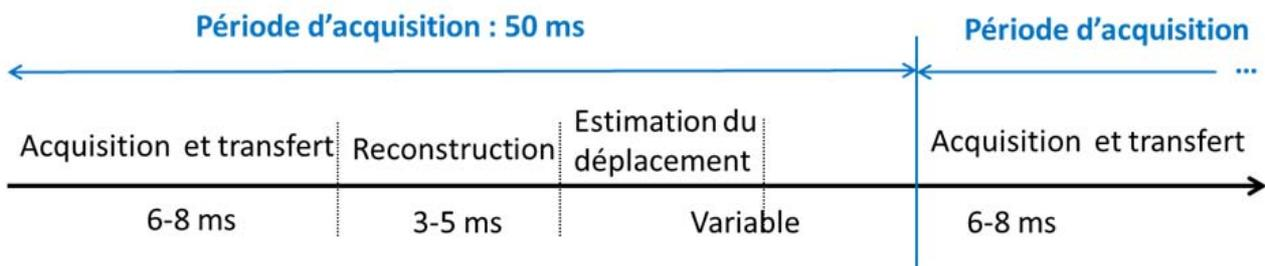
Figure 2.8 : chronogramme de la séquence d'imagerie synchrone utilisée pour une ROI de  $100 \times 50$  pixels. Le temps d'estimation est variable selon le mouvement testé (1D ou 2D) et les paramètres de l'algorithme utilisés.
