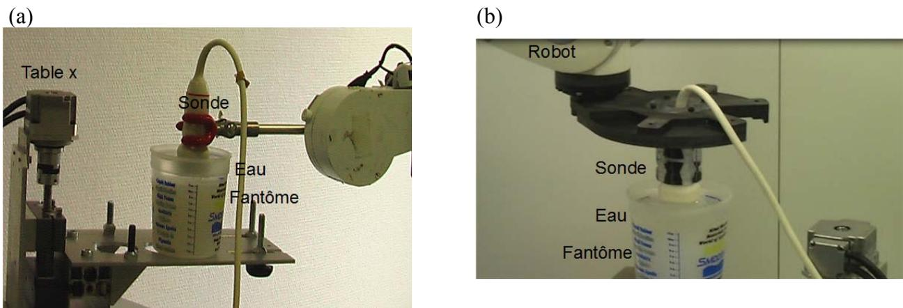
Figure 2.35 : expériences de compensation d'un mouvement 1D avec le robot Sinters (a), avec le robot Viper de ADEPT (b).
