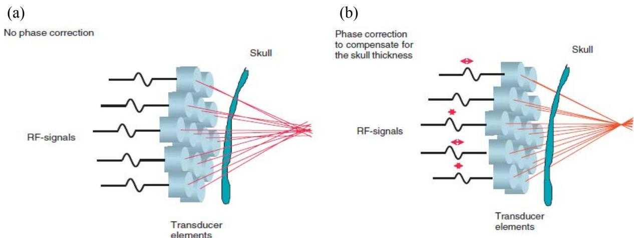
Figure 1.6 : refocalisation des faisceaux défocalisés par le crâne [17]
