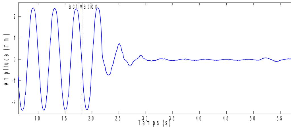
Figure 2.39 : mouvement estimé par imagerie ultrasonore pendant la compensation du mouvement avec le correcteur répétitif et le filtre  $Q_1$  (robot Viper de ADEPT).
