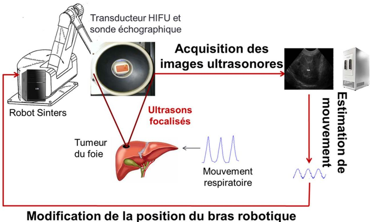
Figure 2.1 : schéma du système HIFU robotisé.
