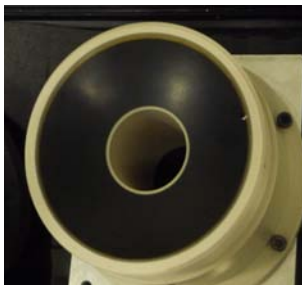
Figure 3.1 : transducteur HIFU utilisé dans le cadre de cette étude.
