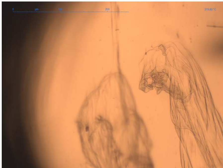
FIGURE 4.18 – Cliché d'une expérience de rétractation de la goutte déformée. Apparition d'un bloc « non divisible ».
