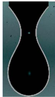
FIGURE 4.2 – Schéma du necking dans une expérience de la goutte pendante [78].
