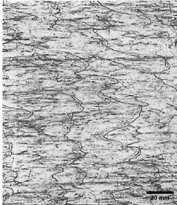
FIGURE 1.32 – Photographie montrant l'irrégularité interfaciale du film coextrudé composé de trois couches de polymère [45]. La direction de la co-extrusion va de gauche à droite horizontalement. Les vagues apparentes de plusieurs dizaines de millimètres ne sont pas situées à la surface, mais bien sur l'une ou plusieurs interfaces internes.
