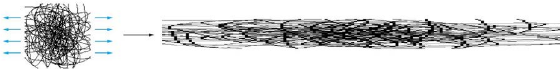
FIGURE 1.11 – Effet de l'étirage biaxial sur l'orientation des chaînes de polymère à l'état amorphe.
