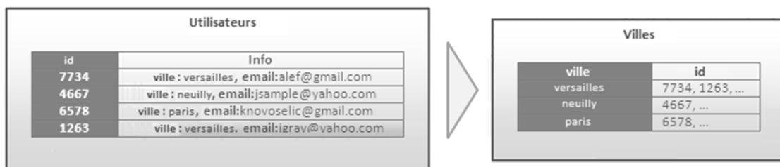
Figure 31 : Exemple de table d'index
