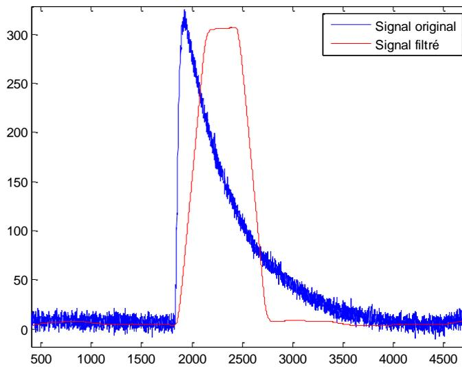
Figure 1-20 : Résultat du filtre trapézoïdal configuré pour avoir un sommet plat le plus large possible.
