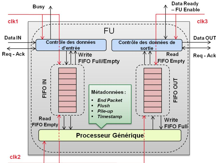
Figure 4-10 : Modèle de FU programmable pour le traitement des impulsions.
