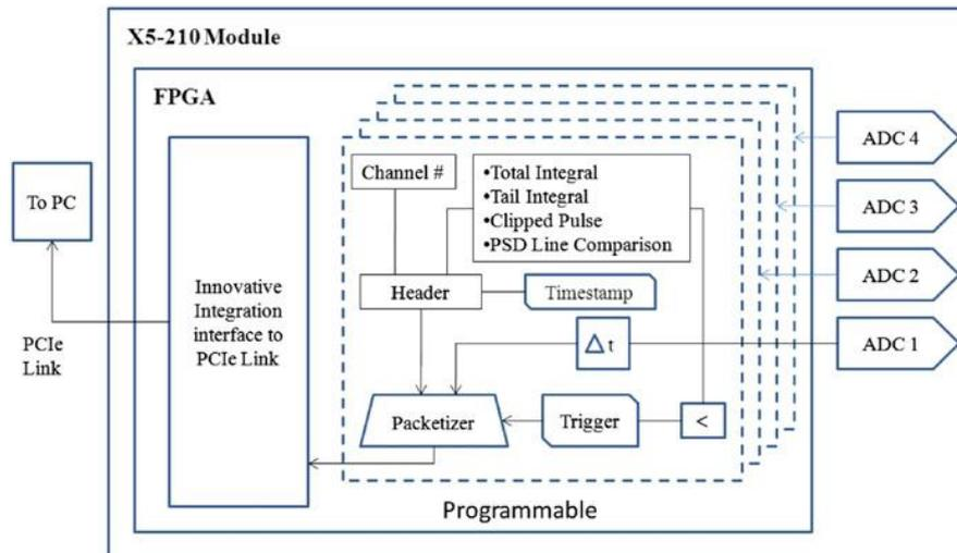
Figure 1-31 : Architecture du FPGA du module X5-210.
