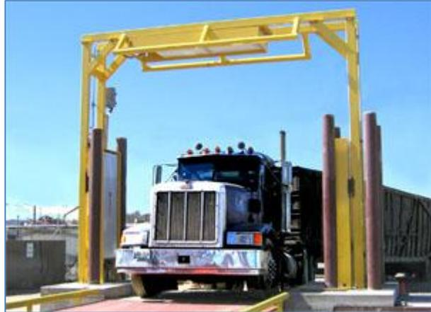
Figure 1-1 : Un portique de détection pour véhicules routiers.
