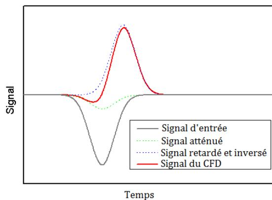
Figure 1-18 : Exemple d'une discrimination à fraction constante
