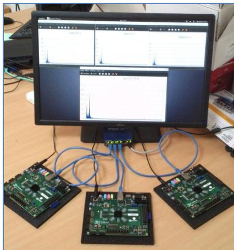
Figure 4-16 : Maquette de l'architecture équipée de trois ZedBoards.
