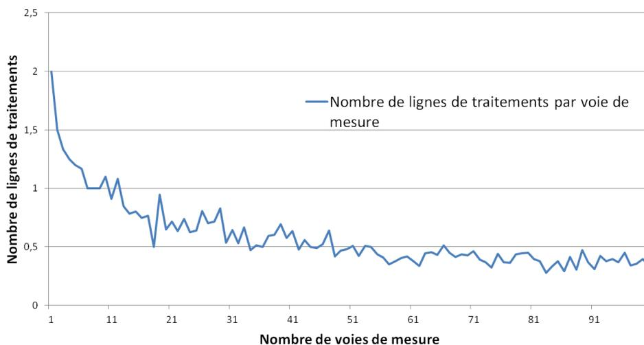
Figure 2-18 : Evolution du nombre de ressources nécessaires au zéro-temps mort par détecteur en fonction du nombre de détecteurs pour un taux de comptage donné ( $10^5\text{ cps}$ ).
