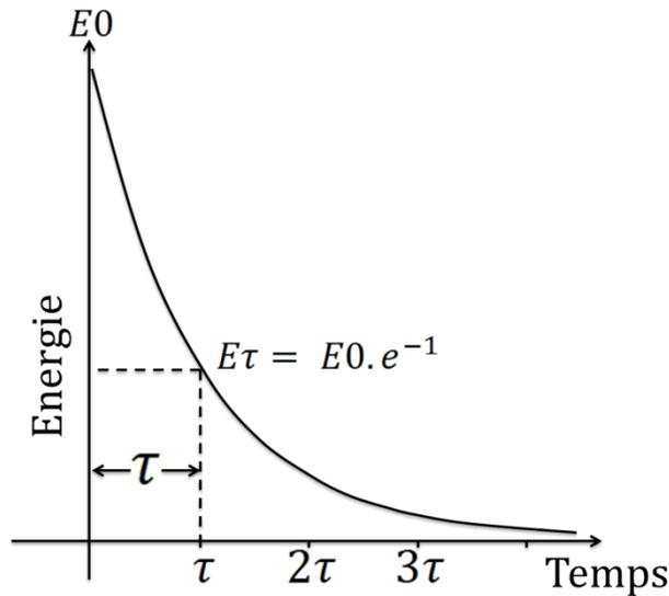
Figure 3-7 : Caractéristiques mathématiques d'une décroissance exponentielle.
