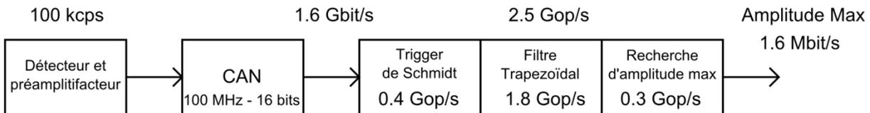
Figure 1-25 : Schéma bloc du système programmable de spectrométrie analysé
