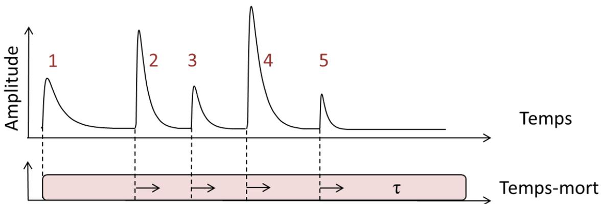
Figure 1-9 : Illustration de la problématique de temps mort paralysable. Dans cet exemple, seule l'impulsion 5 est traitée.
