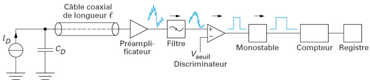
Figure 1-11 : Synoptique d'une chaîne de mesure en mode comptage
