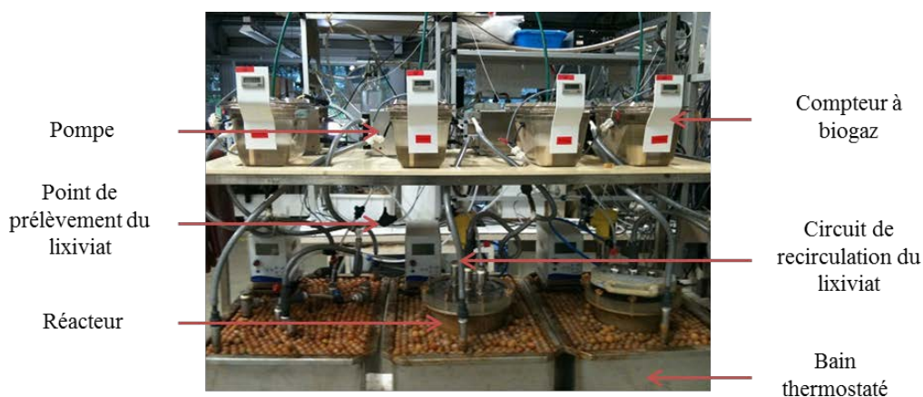
Figure 15 : Photo d'une partie du pilote de méthanisation par voie sèche
