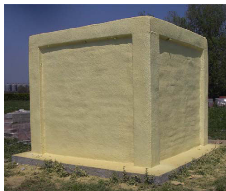
(b) Cabine avec isolation en polyuréthane
