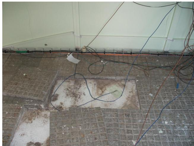
*Figure III.9 : Capteurs de mesure de température et flux au niveau du plancher*
