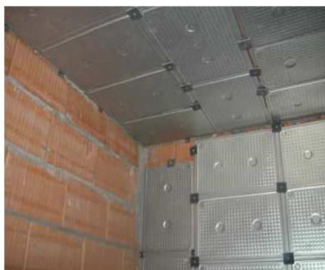
(e) Cabine en brique alvéolaire avec MCP (SP-25 A8)
