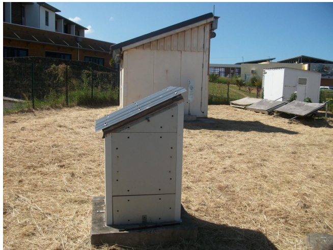
Figure III.4 : Photo d'une cellule ISOTEST et de la cellule LGI
