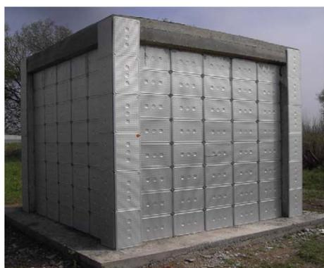
(c) Cabine avec isolation en polyuréthane et MCP (RT-27)
