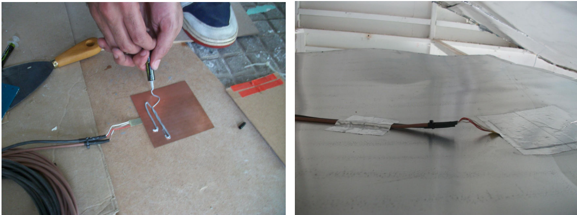
(a) Application d'une pâte thermo-conductrice.
