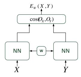
FIGURE 1 – Architecture du SNN originel. Deux réseaux partageant un même ensemble de poids W prennent deux échantillons  $\mathbf{X}$  et  $\mathbf{Y}$  en entrée, dans le but de calculer une erreur relative à une fonction de similarité définie sur l'espace de sortie (ici, la similarité cosinus), au moyen des vecteurs de sortie respectifs  $\mathbf{O}_{\mathbf{X}}$  et  $\mathbf{O}_{\mathbf{Y}}$ .
