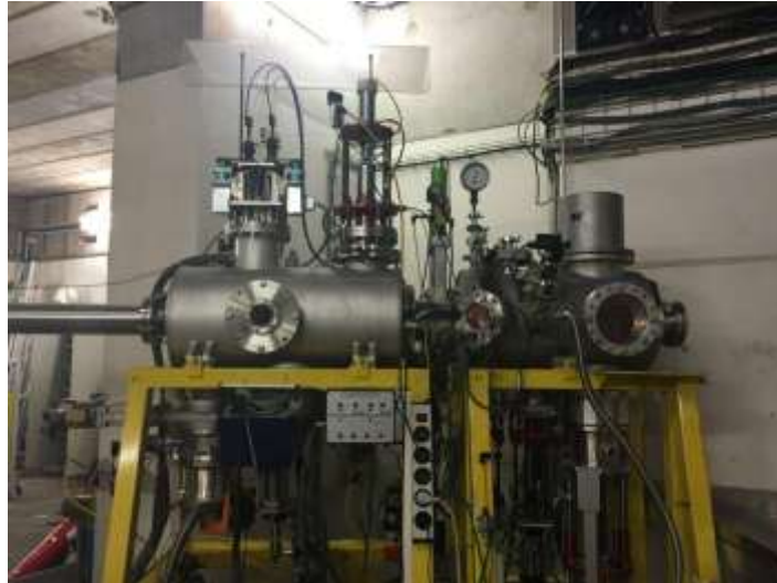
Photographie 6 : Fin de ligne et chambre d'irradiation de la ligne haute énergie IRRABAT
