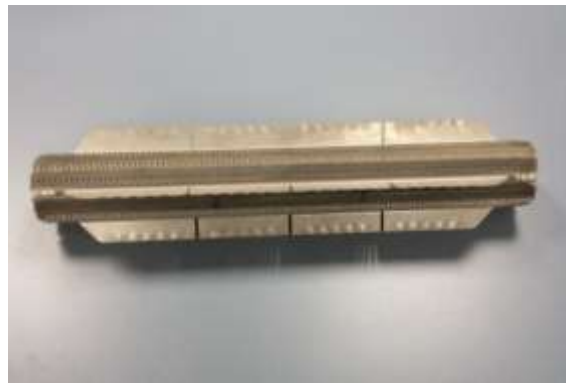
Photographie 1 : Gaine de combustible pour réacteur UNGG
