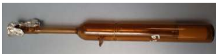
Photographie 3 : Ampoules de 100 ml après irradiation gamma
