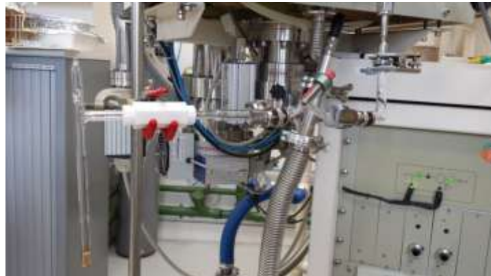
Photographie 8 : Dispositif pour analyse de gaz par spectromètre de masse
