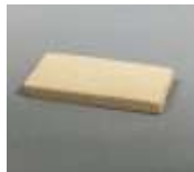
Photographie 7 : Plaquette de géopolymère avant d'être irradiée avec des ions lourds
