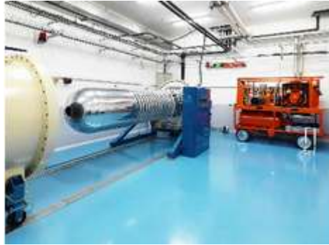
Photographie 4 : Accélérateur d'électrons SIRIUS
