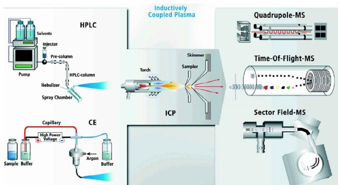
**Figure 20 : configurations instrumentales classiques des couplages avec l'ICP-MS [53]**
