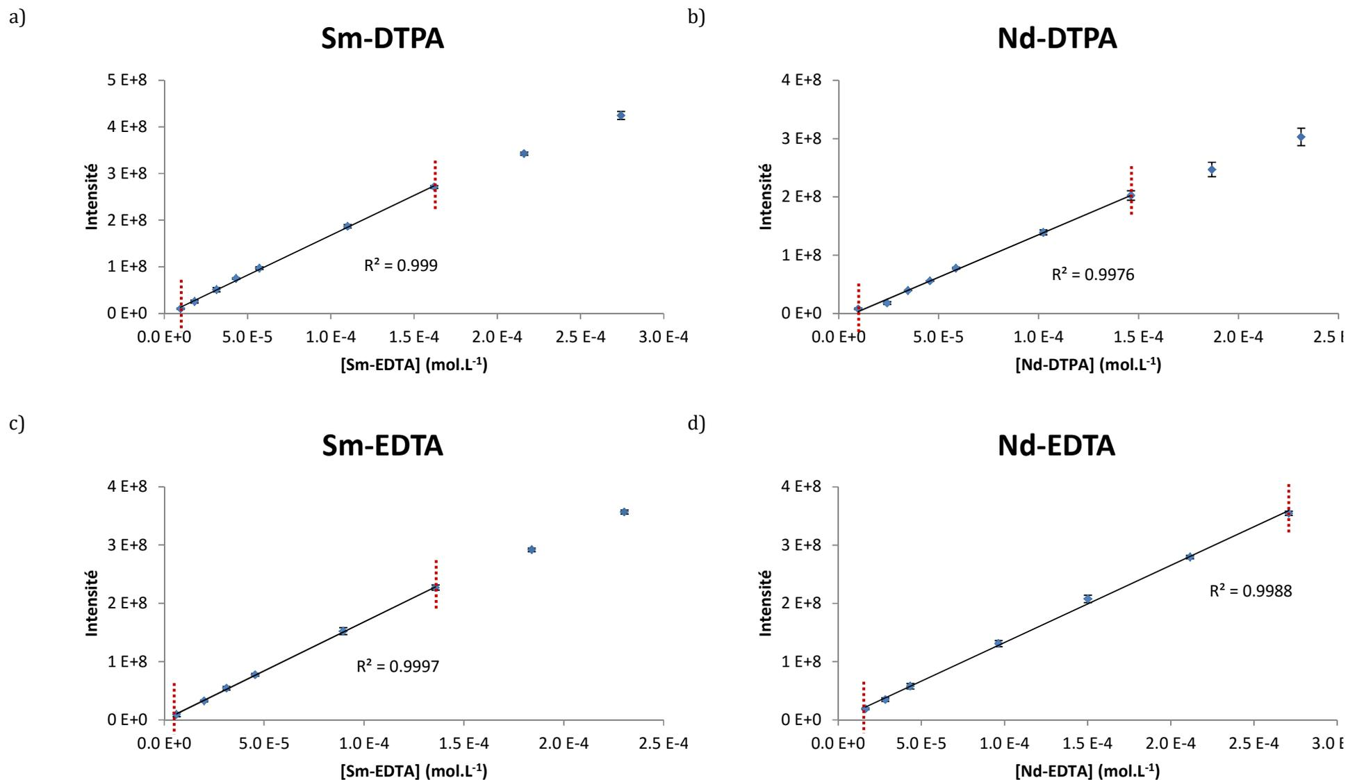
**Figure 56 : variation de l'intensité des complexes de lanthanide séparés par HILIC ESI-MS en fonction de la concentration de chaque espèce : a) Sm-DTPA, b) Nd-DTPA, c) Sm-EDTA d) Nd-EDTA. Les droites noires : droites de régression linéaire. Droites rouges pointillées : limites du domaine de linéarité validées par les tests statistiques**
