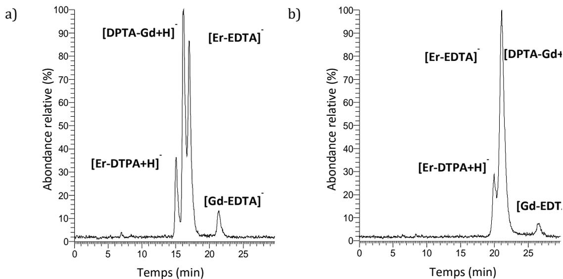
**Figure 38 : séparation des complexes Ln-DTPA et Ln-EDTA (Gd, Er) avec a) la colonne XBridge et b) la colonne TSK gel. Phase mobile : 68/32 (v/v) acétonitrile/eau, 0,5 % d'acide formique ;  $[\text{NH}_4\text{CH}_3\text{COO}] = 20 \text{ mmol.L}^{-1}$ . Débit =  $0,15 \text{ mL.min}^{-1}$ .  $V_{\text{inj}} = 5 \mu\text{L}$ .  $[\text{Nd}] = [\text{Gd}] = [\text{Er}] = 1.10^{-4} \text{ mol.L}^{-1}$**
