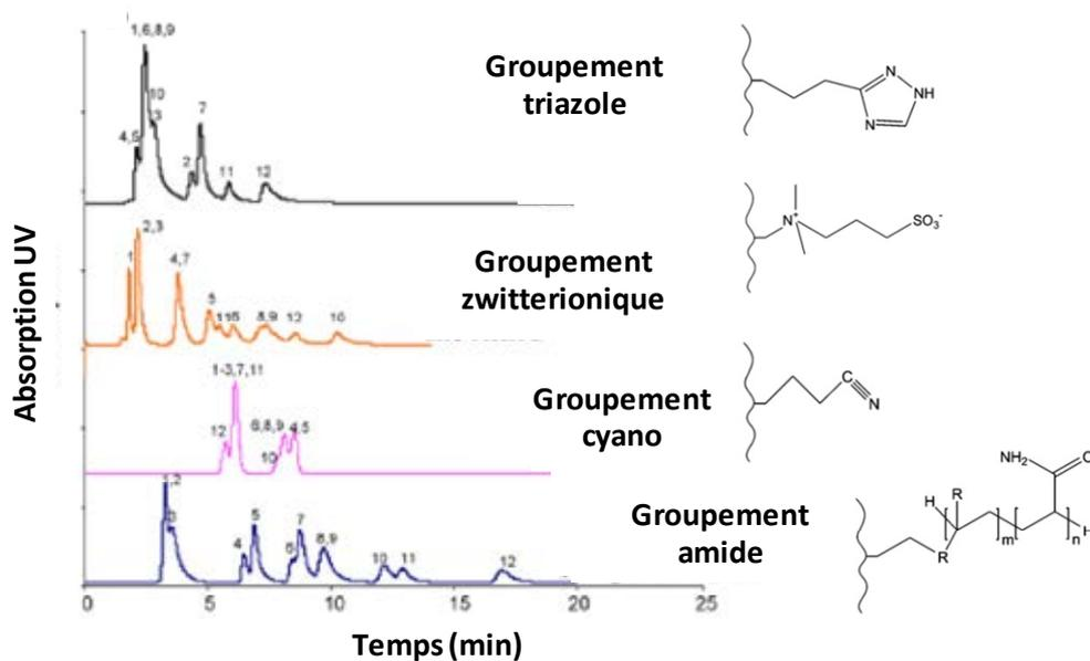
**Figure 11 : séparation de neurotransmetteurs dans les mêmes conditions de phase mobile, avec différents types de phases stationnaires. Phase mobile : 80/20 acétonitrile/eau (v/v), [acétate d'ammonium] = 20 mM, pH 3 [29]**
