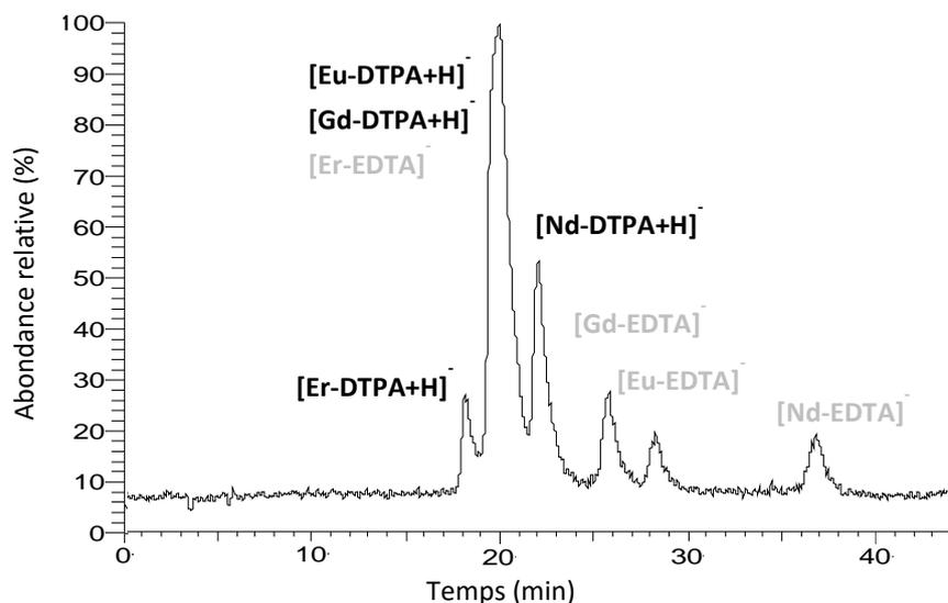
**Figure 42 : chromatogramme de la séparation des complexes Ln-DTPA et Ln-EDTA (Nd, Eu, Gd, Nd) en mode isocratique. Colonne XBridge : 150 x 2,1 mm, 3,5 µm. Phase mobile : ACN/H<sub>2</sub>O (70/30) [NH<sub>4</sub>CH<sub>3</sub>COO] = 15 mmol.L<sup>-1</sup> 0,5 % d'acide formique. Débit = 0,15 mL.min<sup>-1</sup>. V<sub>inj</sub> = 5 µL Proportion Ln:EDTA:DTPA 2:1,75:0,75 [Nd] = [Eu] = [Gd] = [Er] = 1.10<sup>-4</sup> mol.L<sup>-1</sup>**
