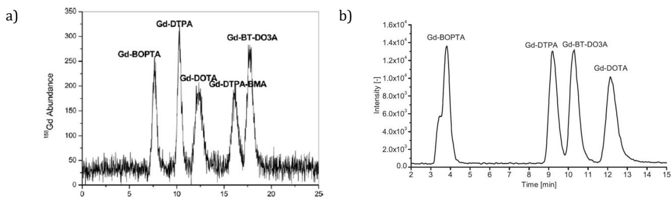
**Figure 24 : séparation d'agents de contraste par HILIC ICP-MS a) avec une phase stationnaire zwitterionique (conditions voir Tableau 10 [118]) b) avec une phase stationnaire de silice vierge à particules superficiellement poreuses (conditions voir Tableau 10 [114]). Les structures des complexes sont présentées en annexe 1**
