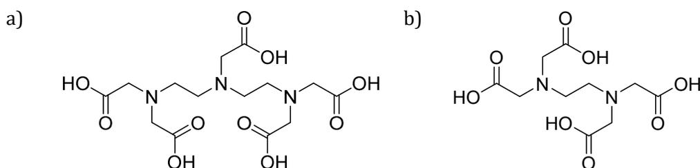
Figure 6 : structure a) du DTPA b) de l'EDTA
