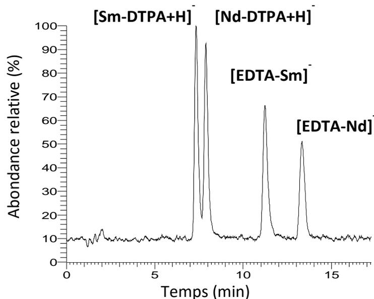
**Figure 45 : séparation des complexes de samarium et de néodyme à ligands EDTA et DTPA. Colonne Acquity (100 x 2,1 mm, 1,7 μm), 70/30 (v/v) ACN/H<sub>2</sub>O ; [NH<sub>4</sub>CH<sub>3</sub>COO] = 15 mmol.L<sup>-1</sup> ; 0,5 % d'acide formique. Débit = 0,3 mL.min<sup>-1</sup>. V<sub>inj</sub> = 3 μL; proportion Ln:EDTA:DTPA 2:1,75:0,75 ; [Sm] = [Nd] = 1.10<sup>-4</sup> mol.L<sup>-1</sup>**
