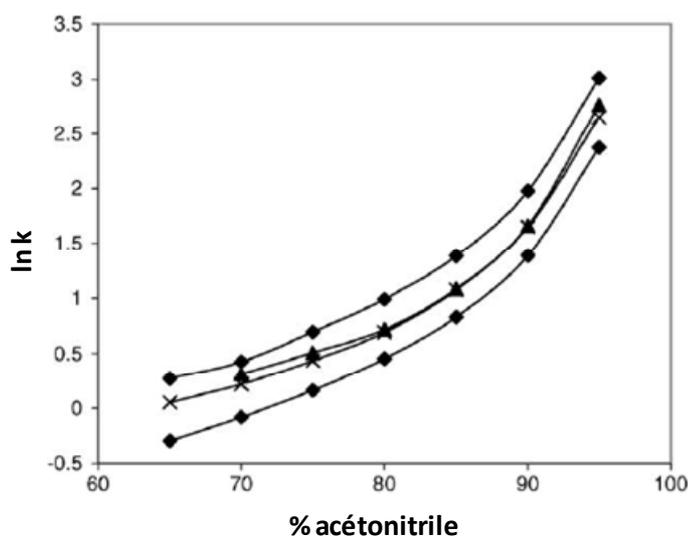
**Figure 13 : variation du facteur de rétention de la cytosine en fonction du pourcentage d'acétonitrile et de la phase stationnaire. Groupements amine (carré), zwitterionique (croix), amide (losange) et silice vierge (triangle). Phase mobile : acétonitrile/eau contenant 5 mM d'acétate d'ammonium [36]**
