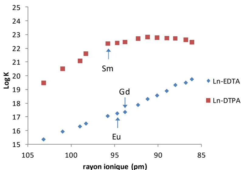
**Figure 7 : évolution des constantes de complexation absolues des complexes Ln-EDTA (en bleu) et Ln-DTPA (en rouge) en fonction du rayon ionique (échelle décroissante) ; données issues des tableaux 1 et 3 [10,15,16]**
