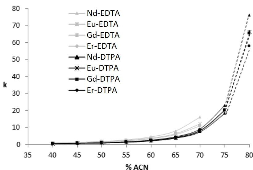
Figure 39 : évolution du facteur de rétention des complexes de lanthanides (Nd, Eu, Gd, Er) en fonction du pourcentage d'acétonitrile. Colonne XBridge (150 x 2,1 mm, 3,5 µm), [NH<sub>4</sub>CH<sub>3</sub>COO] = 15 mmol.L<sup>-1</sup> 0,5 % d'acide formique. Débit : 0,15 mL.min<sup>-1</sup>, V<sub>inj</sub> = 5 µL.
