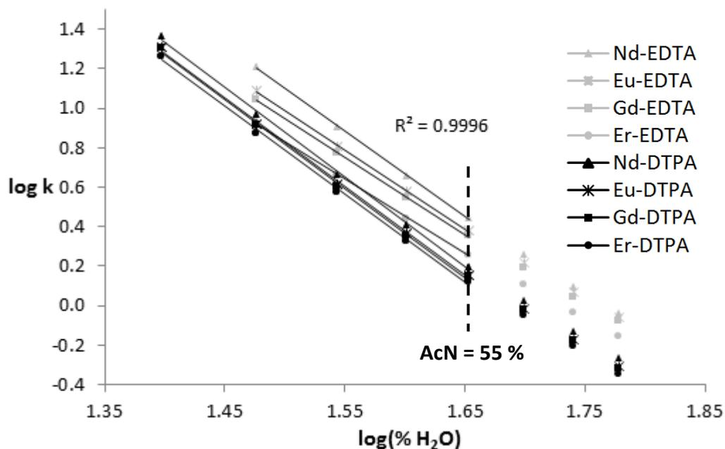
Figure 41 : évolution du  $\log k$  en fonction du  $\log \% \text{H}_2\text{O}$  pour les complexes Ln-DTPA et Ln-EDTA (Nd, Eu, Gd, Er) ; colonne XBridge (150 x 2,1 mm, 3,5  $\mu\text{m}$ ),  $[\text{NH}_4\text{CH}_3\text{COO}] = 15 \text{ mmol.L}^{-1}$  0,5 % d'acide formique. Débit : 0,15  $\text{mL.min}^{-1}$ ,  $V_{\text{inj}} = 5 \mu\text{L}$ .
