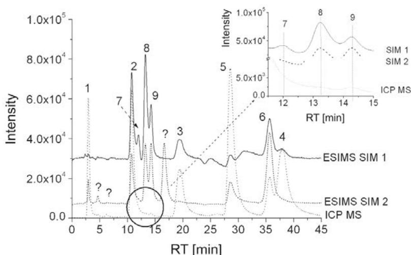
**Figure 29 : séparation d'organoarséniés par HILIC ESI-MS et HILIC ICP-MS en mode gradient. SIM 1 et SIM 2 correspondent aux deux modes de détection appliqués en ESI-MS [110] (colonne ZIC-HILIC ( $150 \times 2,1 \text{ mm}$  ;  $3,5 \mu\text{m}$ ) ; phase mobile : gradient de 78/22 à 70/30 ACN/Acétate d'ammonium ( $125 \text{ mmol.L}^{-1}$ , pH 8,3))**
