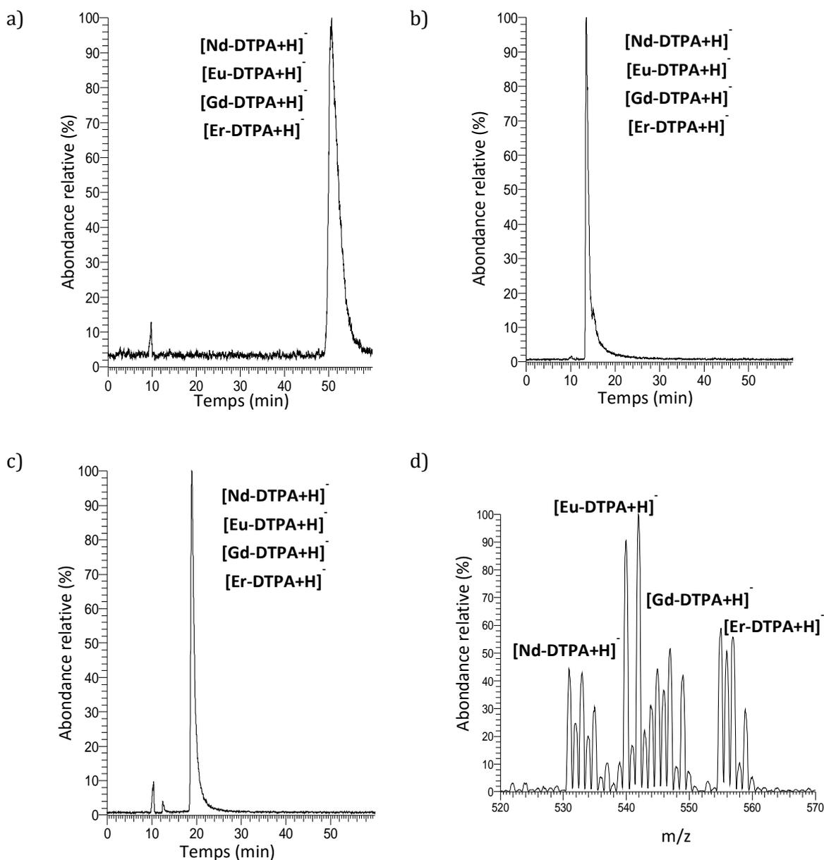
**Figure 35 : chromatogrammes des complexes Ln-DTPA dans les proportions Ln:DTPA 1:1,25 avec  $[Nd] = [Eu] = [Gd] = [Er] = 1.10^{-4} \text{ mol.L}^{-1}$  et avec une phase stationnaire à fonctions a) zwitterioniques b) cyano c) diol. Phase mobile : 70/30 (v/v) acétonitrile/eau  $[NH_4CH_3COO] = 5 \text{ mmol.L}^{-1}$  0,5 % d'acide formique. Débit =  $0,1 \text{ mL.min}^{-1}$ .  $V_{inj} = 5 \mu\text{L}$ . d) spectre de masse extrait du pic chromatographique de la Figure 35a.**
