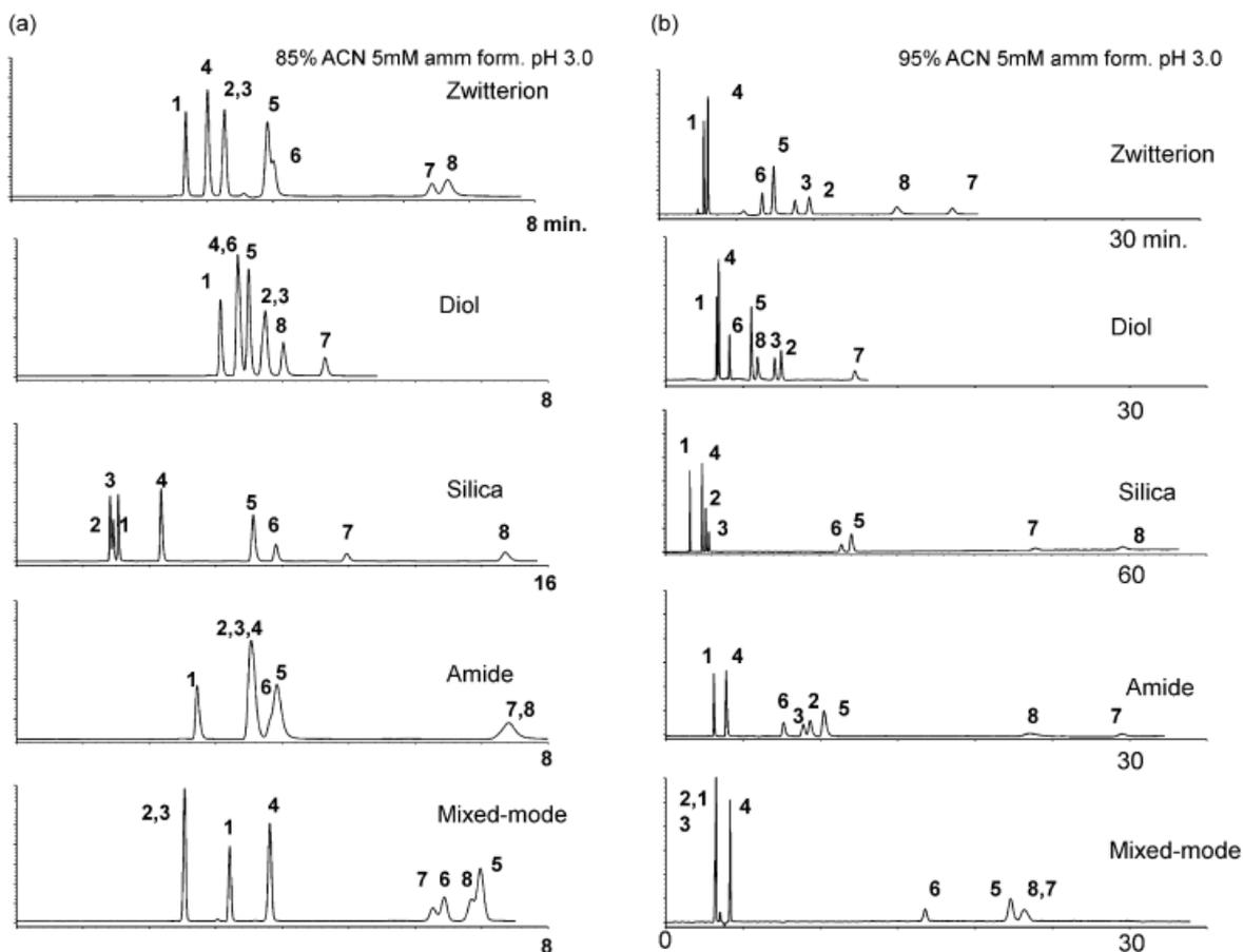
**Figure 12 : séparation de composés polaires avec différentes phases stationnaires. Phase mobile a) 85/15 AcN/H<sub>2</sub>O (v/v) avec 5 mM de formate d'ammonium, pH 3,0 b) 95/05 AcN/H<sub>2</sub>O (v/v) avec 5 mM de formate d'ammonium, pH 3,0 composés : 1) phénol ; 2) acide 2-naphthalènesulfonique ; 3) acide p-xylènesulfonique ; 4) caféine ; 5) nortriptyline ; 6) diphénylhydramine ; 7) benzylamine ; 8) procainamide [28].**
