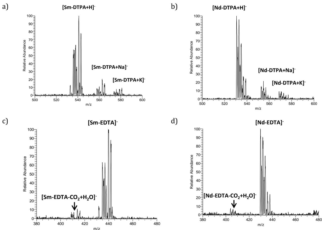
**Figure 46 : spectres de masse ESI-MS en mode d'ionisation négatif extraits de chaque pic chromatographique de la séparation des complexes de samarium et de néodyme à ligands EDTA et DTPA en mode isocratique. a) complexe Sm-DTPA b) complexe Nd-DTPA c) complexe Sm-EDTA d) complexe Nd-EDTA.**
