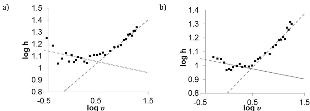
**Figure 37 : courbe de Knox de a) la colonne XBridge (150 x 2,1 mm ; 3,5 $\mu$ m) et b) la colonne TSK gel 80 (. Phase mobile : 68/32 (v/v) acétonitrile/eau [NH<sub>4</sub>CH<sub>3</sub>COO] = 5 mmol.L<sup>-1</sup>; 0,5 % d'acide formique. V<sub>inj</sub> = 5  $\mu$ L**
