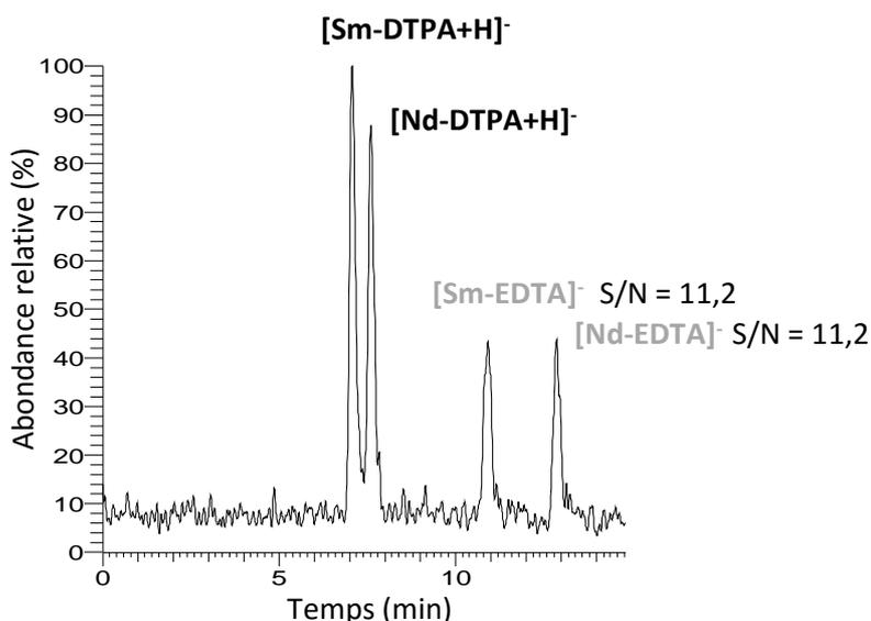
**Figure 55 : séparation des complexes de samarium et de néodyme à ligands EDTA et DTPA. Colonne Acquity (100 x 2,1 mm, 1,7  $\mu\text{m}$ ), 70/30 (v/v) ACN/H<sub>2</sub>O ; [NH<sub>4</sub>CH<sub>3</sub>COO] = 15 mmol.L<sup>-1</sup> ; 0,5 % d'acide formique. Débit = 0,3 mL.min<sup>-1</sup>. V<sub>inj</sub> = 3  $\mu\text{L}$ ; proportion Ln:EDTA:DTPA 2:1,75:0,75 ; [Ln<sub>T</sub>] = 1.10<sup>-4</sup> mol.L<sup>-1</sup> ([Sm] = [Nd])**
