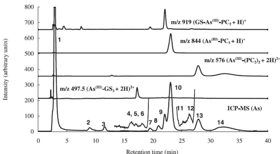
**Figure 27 : séparation de complexes d'arsenic par RP-HPLC couplée simultanément à l'ESI-MS et l'ICP-MS. Phase stationnaire : Spherisorb ODS2 (250×4.6 mm ; 5 μm). Phase mobile gradient eau/méthanol ; acide formique 1 %. PC : phytochelatine ; GS : glutathion. [128]**
