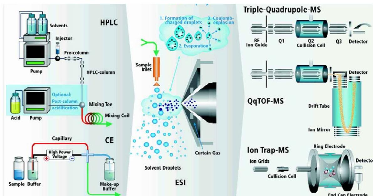
Figure 16 : configurations instrumentales des couplages avec l'ESI-MS [53]
