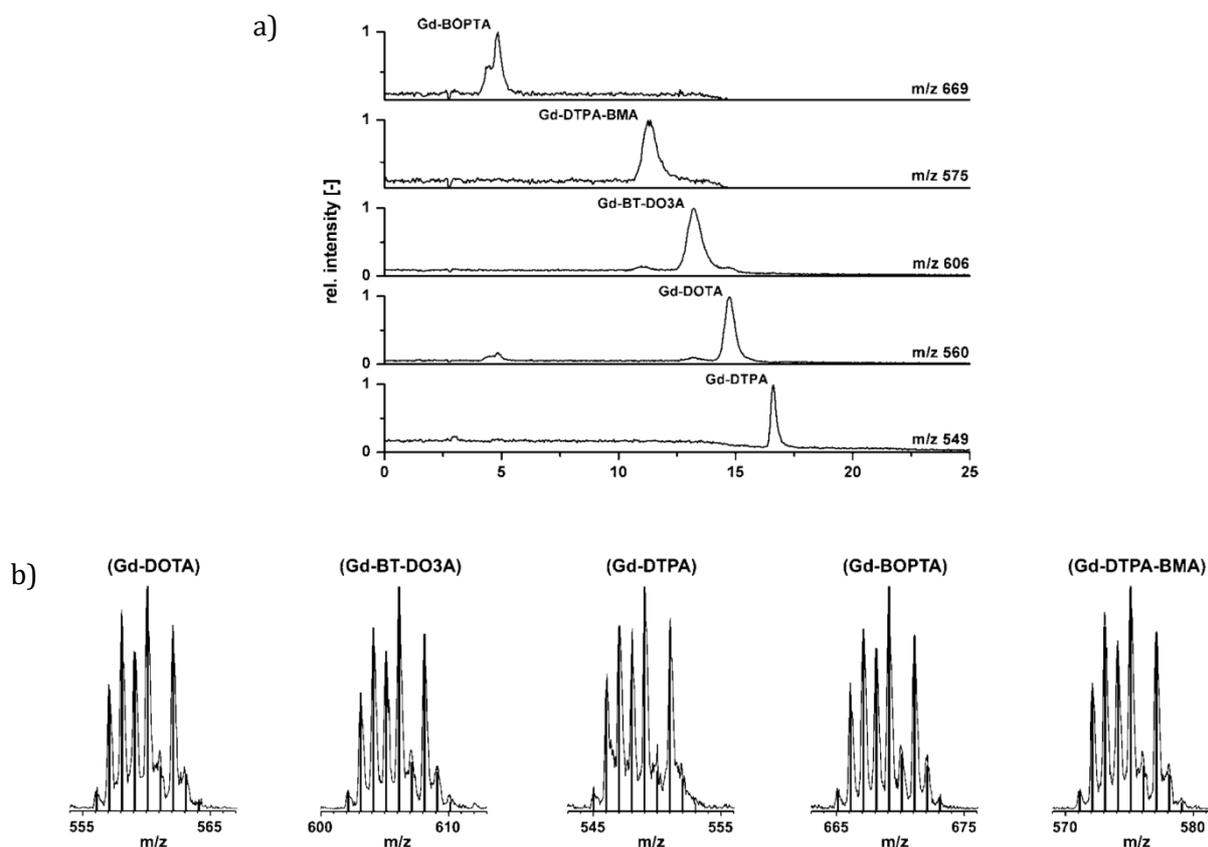
**Figure 26 : a) séparation de complexes de gadolinium (courant d'ion extrait) (conditions chromatographiques voir Tableau 10 [117]) b) spectres de masse de chaque complexe séparé (enveloppe) avec leur spectre théorique (bâtonnet)**
