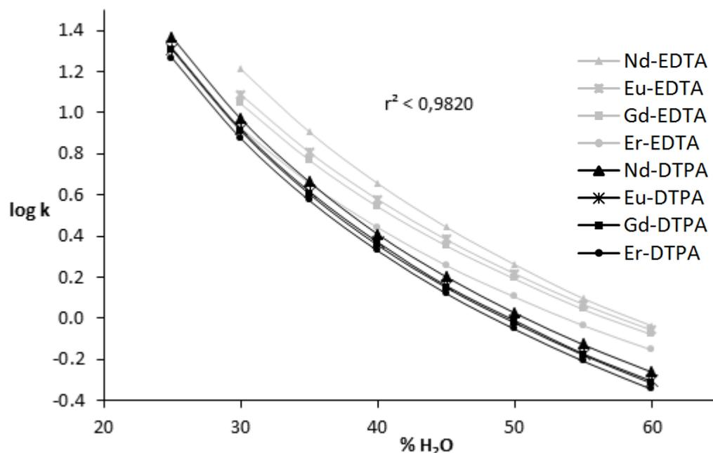
**Figure 40 : évolution du  $\log k$  en fonction du %  $H_2O$  pour les complexes Ln-DTPA et Ln-EDTA (Ln = Nd, Eu, Gd, Er) ; colonne XBridge (150 x 2,1 mm, 3,5  $\mu\text{m}$ ),  $[\text{NH}_4\text{CH}_3\text{COO}] = 15 \text{ mmol.L}^{-1}$  0,5 % d'acide formique. Débit = 0,15  $\text{mL.min}^{-1}$ ,  $V_{inj} = 5 \mu\text{L}$ .**
