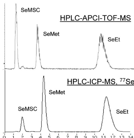
**Figure 28 : séparation d'un échantillon modèle contenant trois organosélénés (SeMSC : Se-méthylsélénométhylcystéine ; SeMet : sélénométhionine ; SeEt : L-Sélénoéthionine) par IP-HPLC couplée simultanément à l'APCI-MS et l'ICP-MS [131] (colonne Supelco Discovery HS C18 (20 x 2,1 mm ; 3  $\mu$ m) ; phase mobile : eau/méthanol 75/25 (v/v) ; [acide formique] = 10 mM ; [acide perfluoroheptanoïque] = 1mM ; pH 2,8)**
