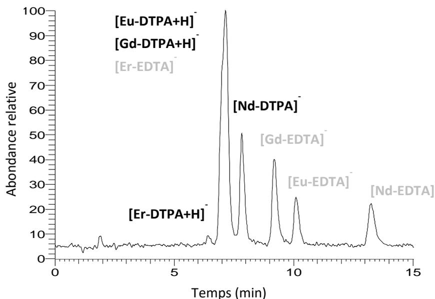
**Figure 43 : chromatogramme de la séparation des complexes Ln-DTPA et Ln-EDTA (Nd, Eu, Gd, Er) en mode isocratique. Colonne Acquity (100 x 2,1 mm, 1,7  $\mu$ m), 70/30 (v/v) acétonitrile/eau [NH<sub>4</sub>CH<sub>3</sub>COO] = 15 mmol.L<sup>-1</sup> 0,5 % d'acide formique. Débit = 0,3 mL.min<sup>-1</sup>.  $V_{inj}$  = 3  $\mu$ L; Proportion Ln:EDTA:DTPA 2:1,75:0,75 ; [Nd] = [Eu] = [Gd] = [Er] = 1.10<sup>-4</sup> mol.L<sup>-1</sup>**
