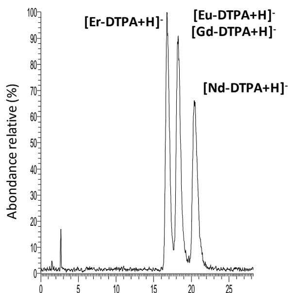
**Figure 36 : chromatogramme des complexes Ln-DTPA dans les proportions Ln:DTPA 1:1,25 avec [Nd] = [Eu] = [Gd] = [Er] =  $1.10^{-4}$  mol.L<sup>-1</sup> et avec la colonne TSK gel amide. Phase mobile : 70/30 (v/v) acétonitrile/eau [NH<sub>4</sub>CH<sub>3</sub>COO] = 5 mmol.L<sup>-1</sup> 0,5 % d'acide formique. Débit = 0,1 mL.min<sup>-1</sup>. V<sub>inj</sub> = 5 µL**
