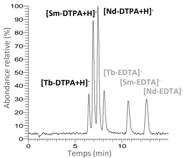
**Figure 50 : séparation des complexes de samarium et de néodyme à ligands EDTA et DTPA avec l'étalon de Tb-DTPA. Conditions chromatographiques voir Figure 45
