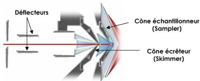
**Figure 18 : interface et optique ionique d'un ICP-MS**
