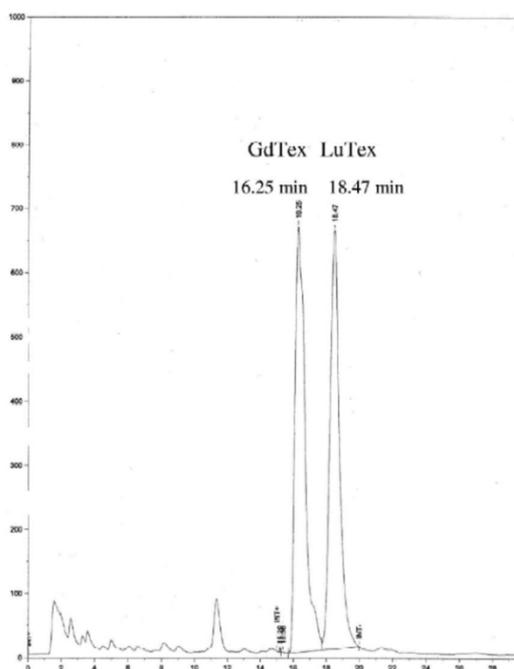
**Figure 22 : séparation de deux complexes de lanthanides, Gd-motexafin (GdTex) et Lu-motexafin (LuTex) par RP-HPLC couplé à la spectrométrie UV dans du plasma humain (colonne Zorbax Eclipse XDB-C 18 (150 x 3 mm, 3,50  $\mu$ m) ; 100 mM d'acétate d'ammonium (pH 4,3)/acétonitrile/méthanol 59/21/20 ; débit = 0,6 mL.L<sup>-1</sup>) [88]**
