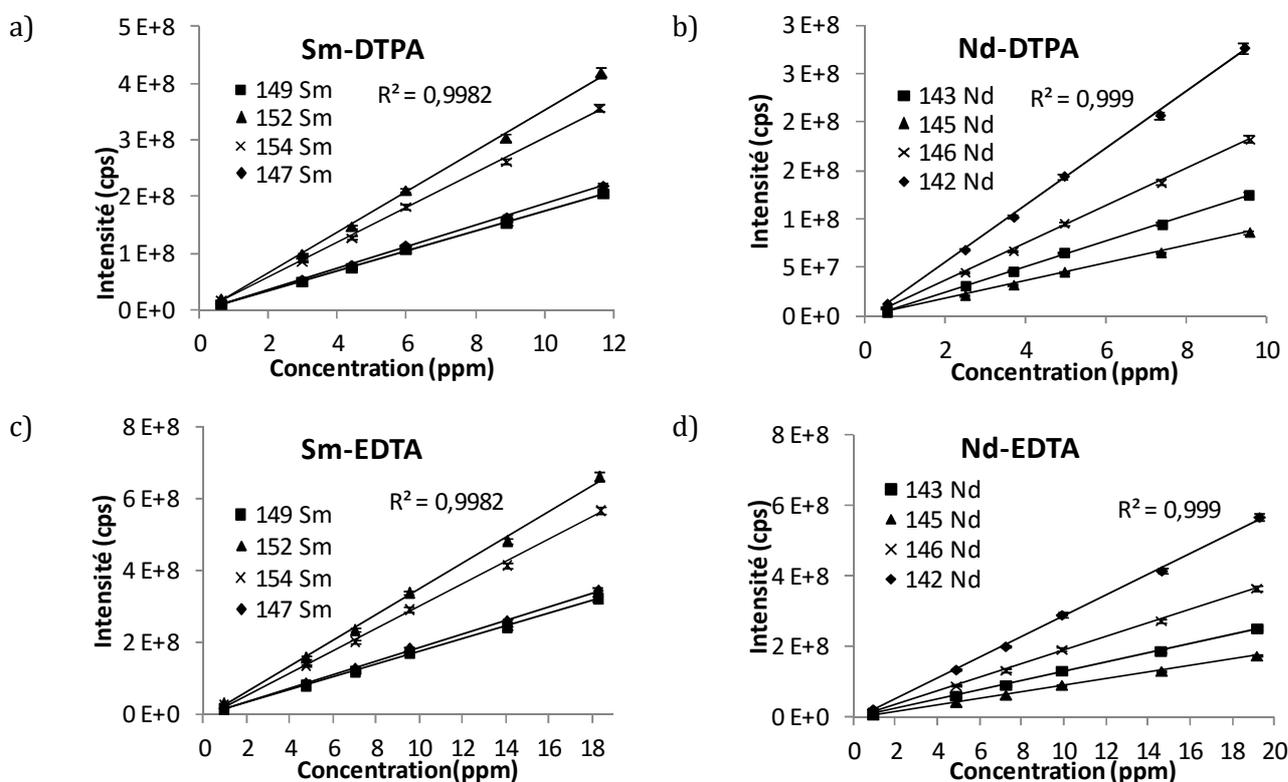
**Figure 65 : droites d'étalonnage moyennes de chaque isotope de lanthanide pour les complexes a) Sm-DTPA b) Nd DTPA c) Sm-EDTA d) Nd-EDTA. Les barres d'erreur associées à chaque niveau de concentration sont également présentées.**
