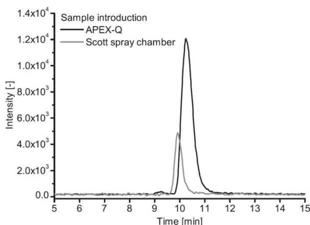
**Figure 25 : comparaison des signaux du Gd-BT-DO3A (annexe 1) obtenus par HILIC ICP-MS ( $c=10$  nmol.L<sup>-1</sup>) en utilisant une chambre de nébulisation de Scott (gris) et un désolvateur (noir) (condition de séparation voir Tableau 10 [114])**
