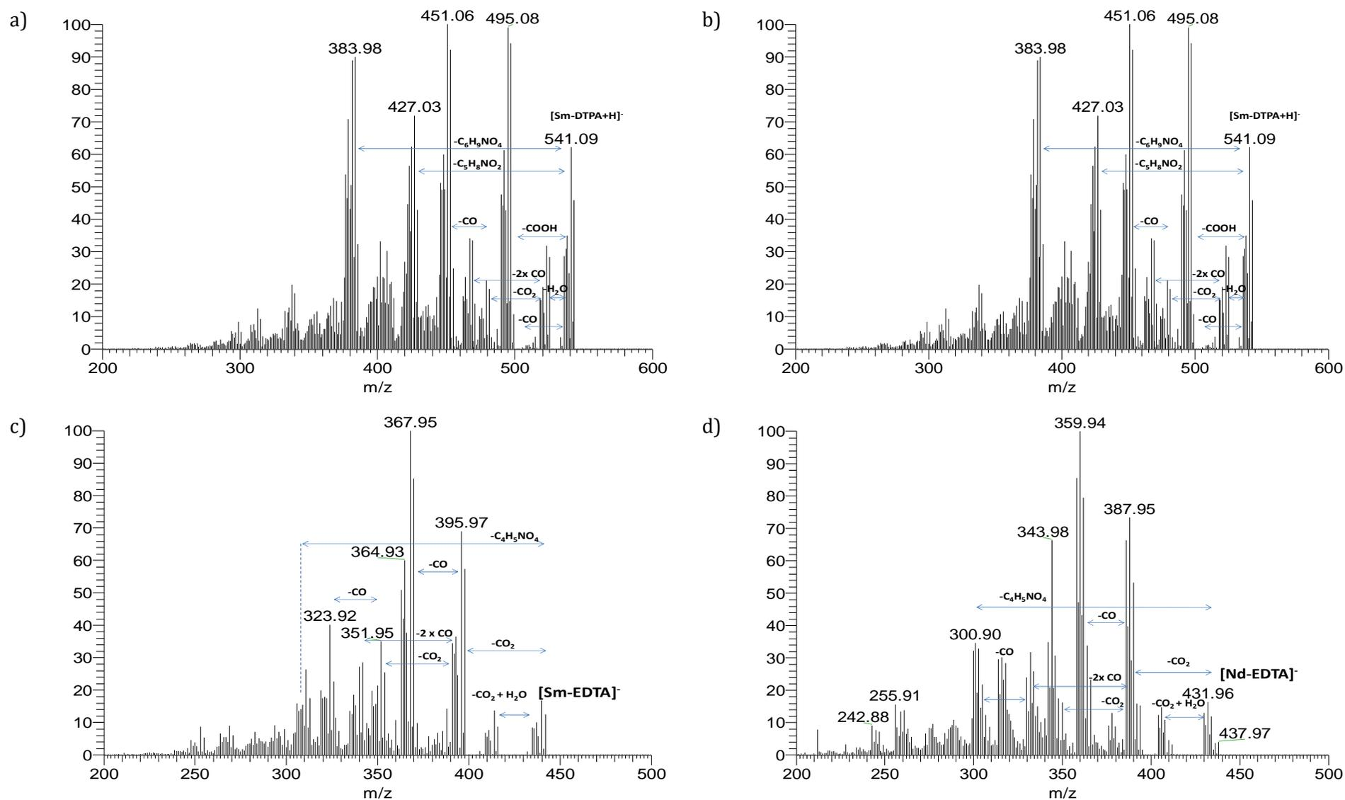
Figure 52 : spectre de fragmentation par ESI-MS, en injection directe avec une énergie de collision de 19 V et un  $\Delta m$  de 10 a) du [Sm-DTPA+H]<sup>-</sup> b) du [Nd-DTPA+H]<sup>-</sup> c) du [Sm-EDTA]<sup>-</sup> d) du [Nd-EDTA]<sup>-</sup>
