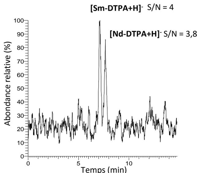
**Figure 54 : séparation des complexes de samarium et de néodyme à ligands EDTA et DTPA. Colonne Acquity (100 x 2,1 mm, 1,7  $\mu\text{m}$ ), 70/30 (v/v) ACN/H<sub>2</sub>O ; [NH<sub>4</sub>CH<sub>3</sub>COO] = 15 mmol.L<sup>-1</sup> ; 0,5 % d'acide formique. Débit = 0,3 mL.min<sup>-1</sup>. V<sub>inj</sub> = 3  $\mu\text{L}$ ; proportion Ln:EDTA:DTPA 2:1,75:0,75 ; [Ln<sub>T</sub>] = 1.10<sup>-5</sup> mol.L<sup>-1</sup> ([Sm] = [Nd])**
