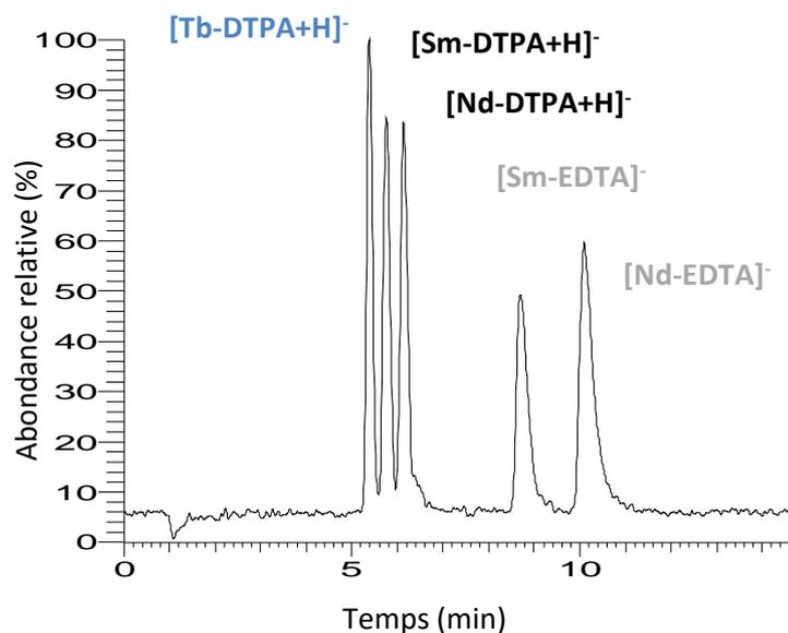
**Figure 51 : séparation des complexes de samarium et de néodyme à ligands EDTA et DTPA avec les étalons de Tb-DTPA à pH 6,8. Conditions chromatographiques voir Figure 45 ; [Sm] = [Nd] = [Tb] =  $1.10^{-4}$  mol.L $^{-1}$**
