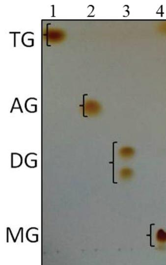
**Figure 120** : Contrôle de la migration des différents réactifs et produits du test triglycéride lipase. **Piste 1** : trioléine ; **piste 2** : acide oléique ; **piste 3** : dioléine ; **piste 4** : monooléine.
