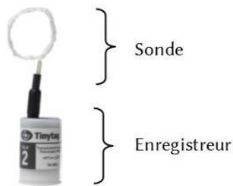
Capteur de température TinyTag Talk 2
