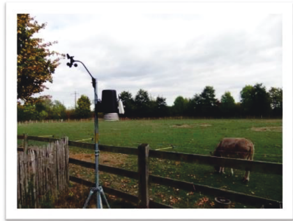
Station météorologique Davis, modèle Vantage Pro 2 . Station installée sur le site de l'Ecomusée à Rennes.
