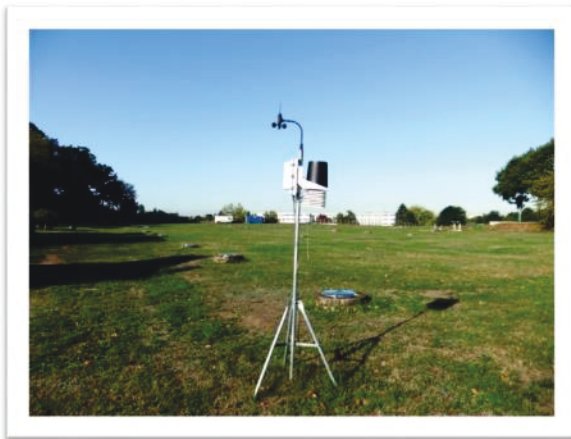
Station météorologique Davis, modèle Weather Monitor II . Station installée sur le site Les Gallets à Rennes.
