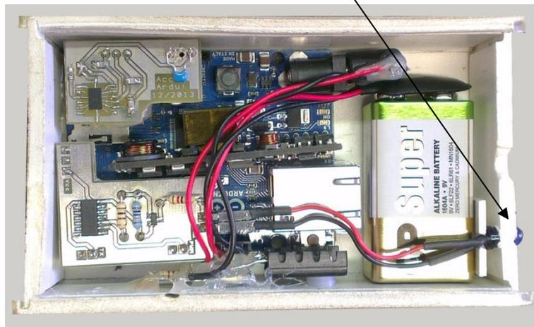
Figure 53 : Insertion du montage dans un boîtier
