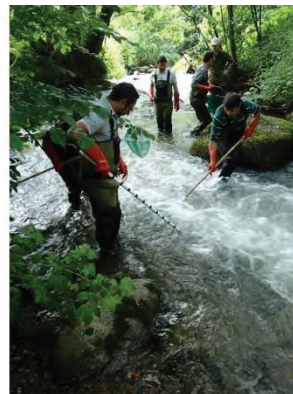
Figure 8. Pêche électrique. A gauche : Anode et épuisette. A droite : Echantillonnage sur la Neste d'Oueil en juillet 2014 (ONEMA - Ecogea).
