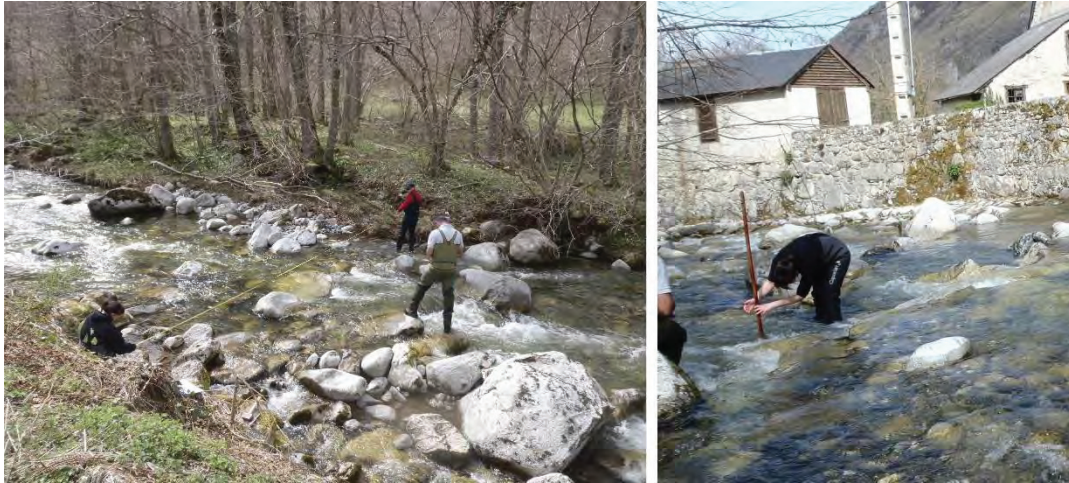
Figure 10. Mesures hydrauliques sur l'Adour de Payolle. A gauche : Mesure de largeur d'un transect sur la station AP3. A droite : Mesure de hauteur d'eau sur AP4.
