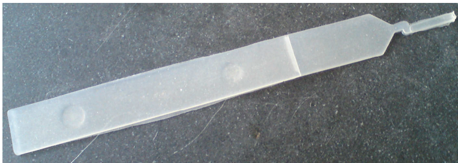
Figure IV.22. Eprouvette de laque d'élastomère rectangulaire injectée pour la nuance LSR4350
