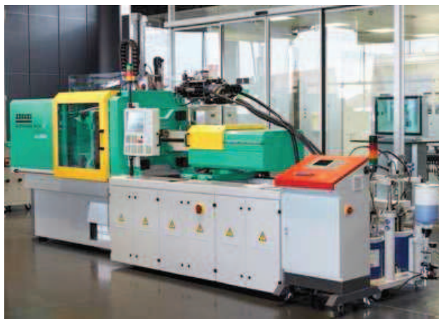
Figure I.15. Presse d'injection électrique ARBURG® Allrounder 470 A dédiée à la mise en forme des élastomères LSR [76]
