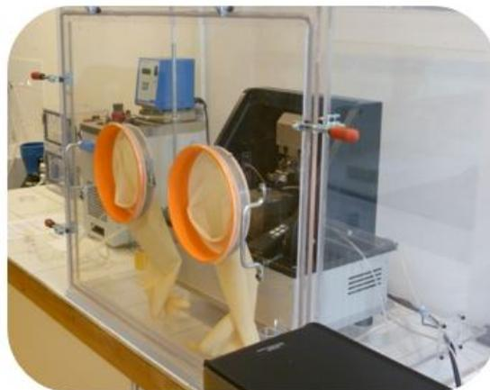
FIGURE 4.20: Nanotribomètre de la société CSM Instruments dans une enceinte environnementale.
