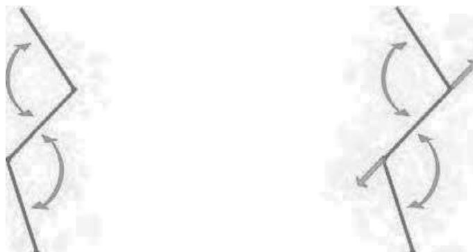
Fig. 5.14 – Représentation schématique des forces d'interaction prise en compte dans les modèles précédents, à gauche, dans la nouvelle théorie de Manning, à droite. Les flèches bleues représentent les interactions qui tendent à aligner le polymère, les rouges celles qui tendent à l'allonger.
