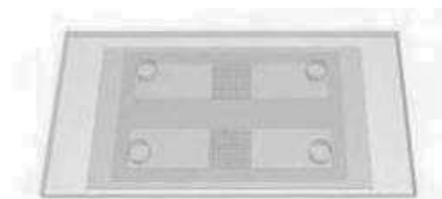
Fig. 3.8 – Schéma de la chambre microfluidique fermée
