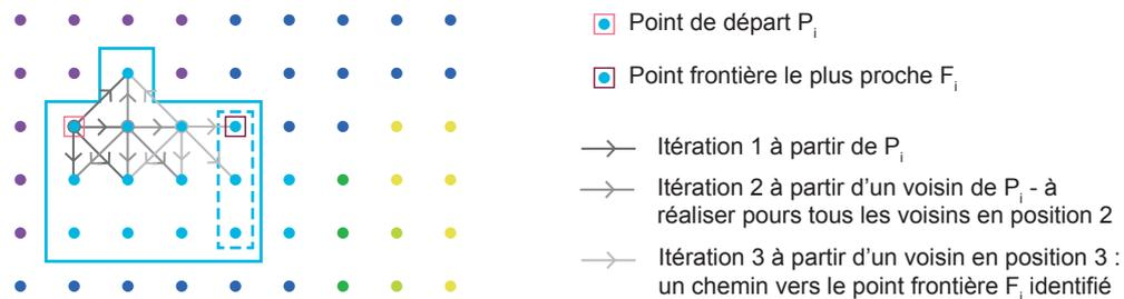
Fig. 4.21 – Exemple de recherche de tous les chemins possibles par itération : première itération sur  $P_i$ , seconde itération sur un voisin de  $P_i$  (à réaliser sur tous les voisins de  $P_i$ ), troisième itération sur un voisin en position 3 (à réaliser sur tous les voisins en position 3).
