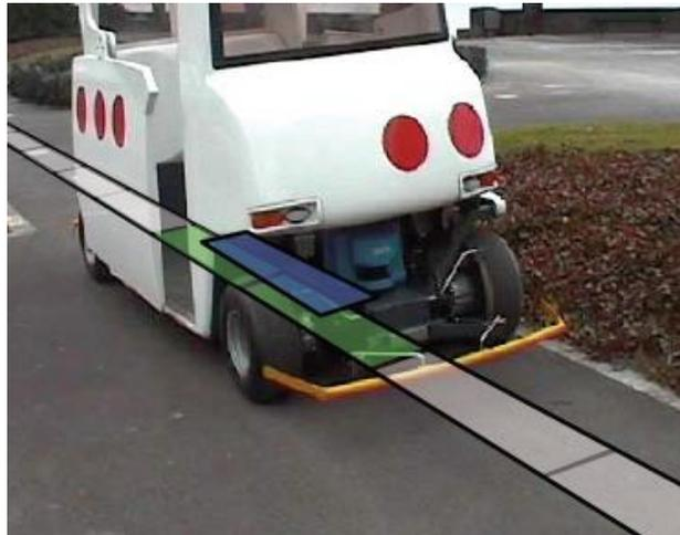
Figure 1-7: Projet Serpentine : 'capsule' autonome alimenté sans contact
