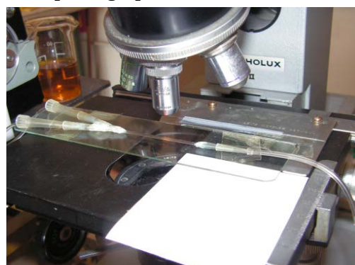
Fig. 51 : Premiers essais de synthèse de ferrofluide dans un canal en Y (projets de L. Raboin et V. Watel).
