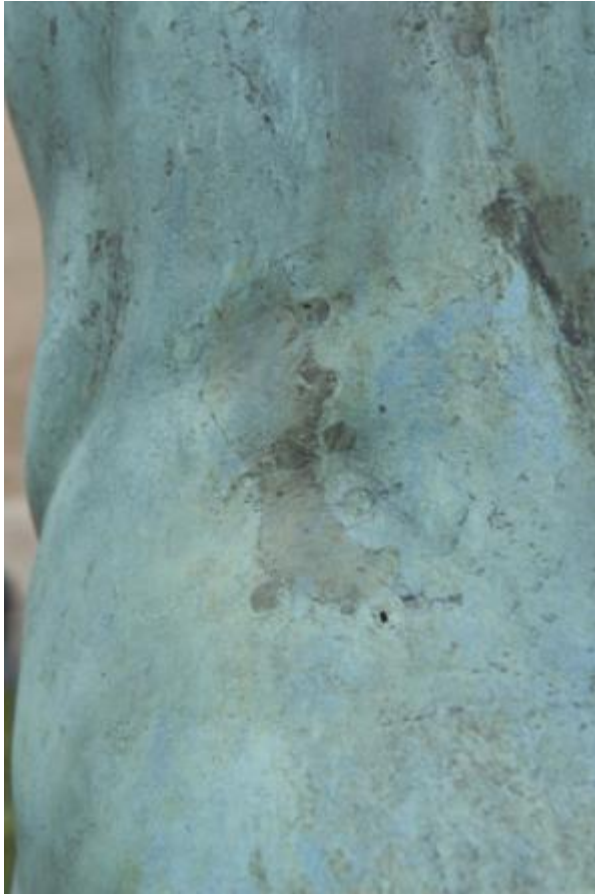
Figure IV 2.2-48 : Gladiateur combattant. Détail du côté gauche du dos qui présente une coulée secondaire renforcée mécaniquement à l'aide de rivets d'un diamètre d'environ 8 mm (flèches rouges) © C2RMF A Maigret
