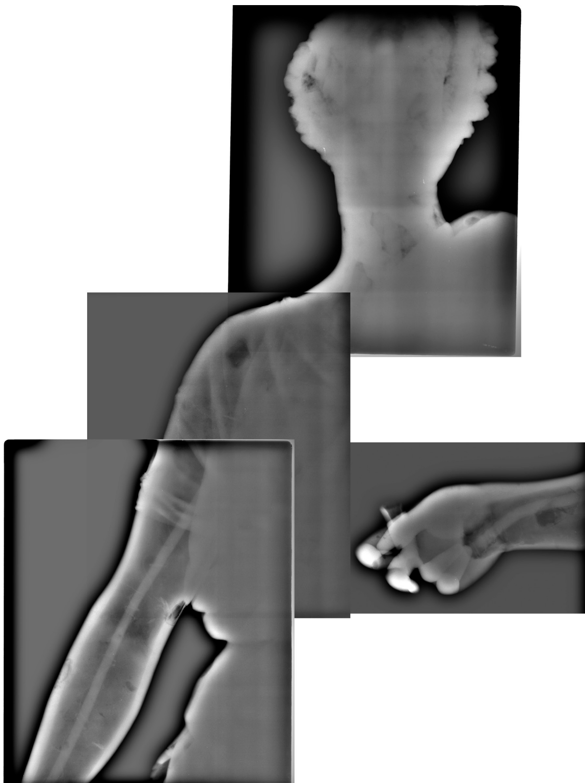
Figure IV 1.2-4 : Prudence. Radiographie \gamma (traitement filtre passe haut) de la partie droite du buste et de la main gauche de la statue. L'épaisseur de la paroi métallique varie de 8 à 18 mm dans le bras et de 25 à 40 mm dans la tête © C2RMF
