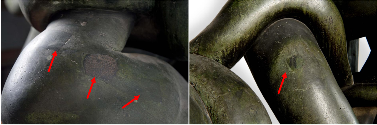
Figure IV 1.1-40 : Laocoon. A gauche : bras droit de l'enfant à gauche du Laocoon, présence de larges plaquettes de réparation (15-20 mm de côtés). A droite : Jambe droite de l'enfant à la gauche du Laocoon, présence d'une plaquette de réparation. © C2RMF A Maigret
