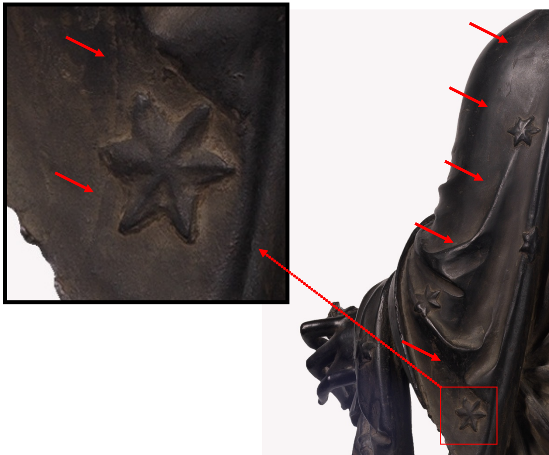
Figure IV 1.3-38 : Justice. Détail de la draperie où une petite ligne de discontinuité du métal (flèches rouges) semble indiquer le positionnement d'une zone de jonction de pièces du moule (côté gauche du dos, sur la draperie) © C2RMF A Maigret
