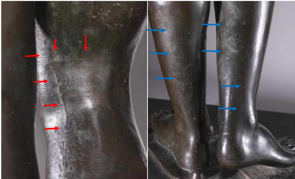
Figure IV 2.2-8 : Vénus Médicis. A gauche : Détail de l'arrière des jambes. Le long de l'intérieur de la jambe droite, on peut voir la trace de la frontière (flèches rouges) entre deux pièces du moules qui n'a pas été éliminé à la ciselure ; On devine également au dessus du genou, la trace du joint de cire également visible en radiographie A droite : Détail de l'arrière des jambes où les zones de jointures de pièces en cire ont retranscrit dans le métal de fins liserés (flèches bleues) © C2RMF A Maigret
