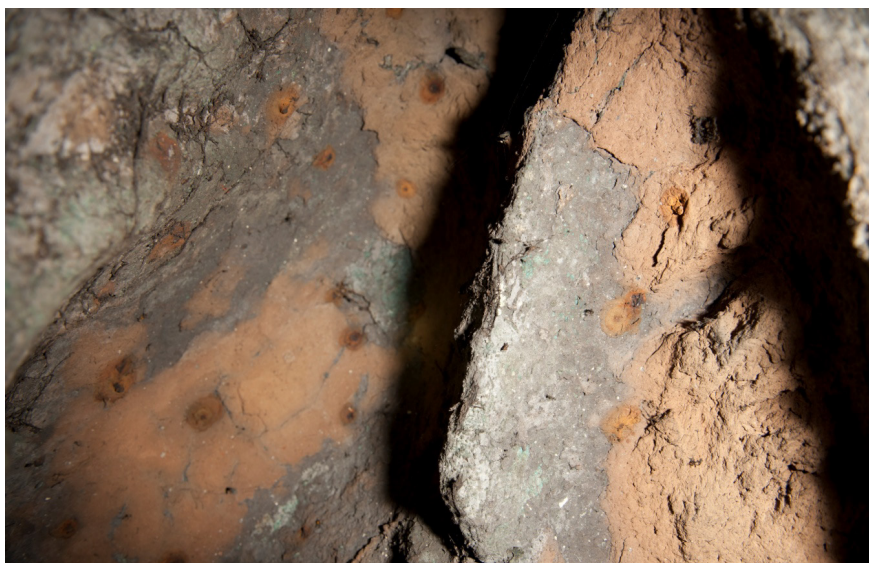
Figure III 2.3-10 : Primatice (maître d'œuvre), Ariane endormie, MR 3284, 1542, Château de Fontainebleau. Paroi interne de la statue. Des fers à noyau (section 5mm) ont formé des auréoles de corrosion dans les restes du noyau adhérents à la paroi © C2RMF A Maigret
