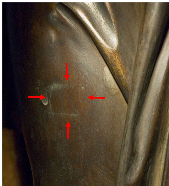
Figure IV 1.3-34 : Paix. Détail de la cuisse droite de la Paix montrant le rebouchage par insert d'une plaque rectangulaire d'un défaut de fonderie et les traces de rifloir sur les chairs et le vêtement © F Bewer
