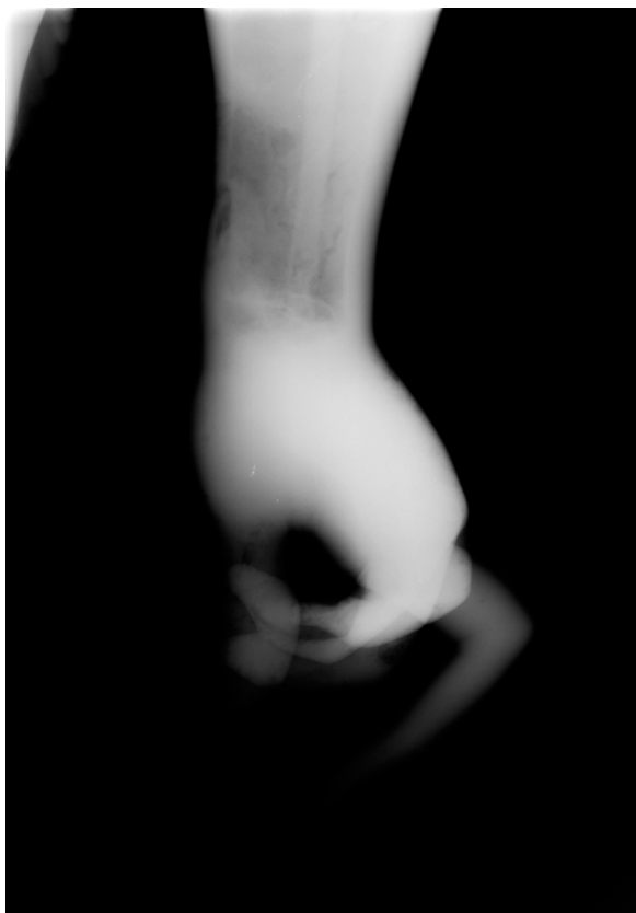
Figure IV 1.2-9 : Prudence. Radiographie \gamma . Détail du bras droit. La main est pleine de métal à partir du poignet. Une armature (15 mm de section) renforce le noyau fonderie et son extrémité, eu niveau du poignet, semble être prise dans la paroi métallique © C2RMF
