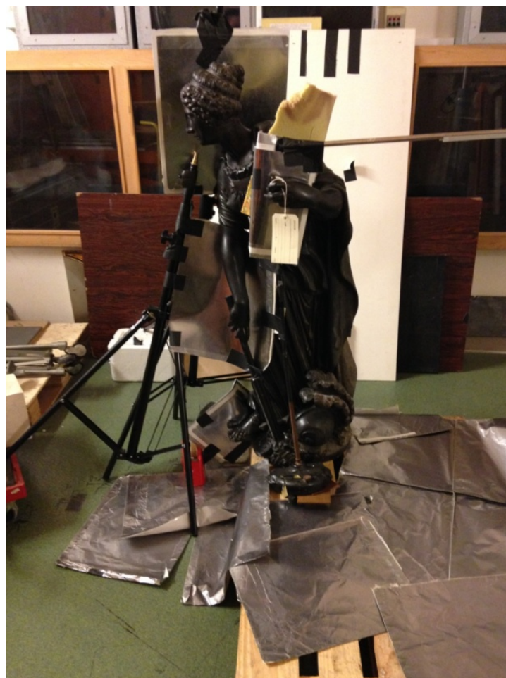
Figure III 2.3-17 : mise en place du dispositif expérimental pour la réalisation de radiographie X de la statue de la Paix du monument de cœur du connétable Anne de Montmorency © C2RMF M.Castelle
