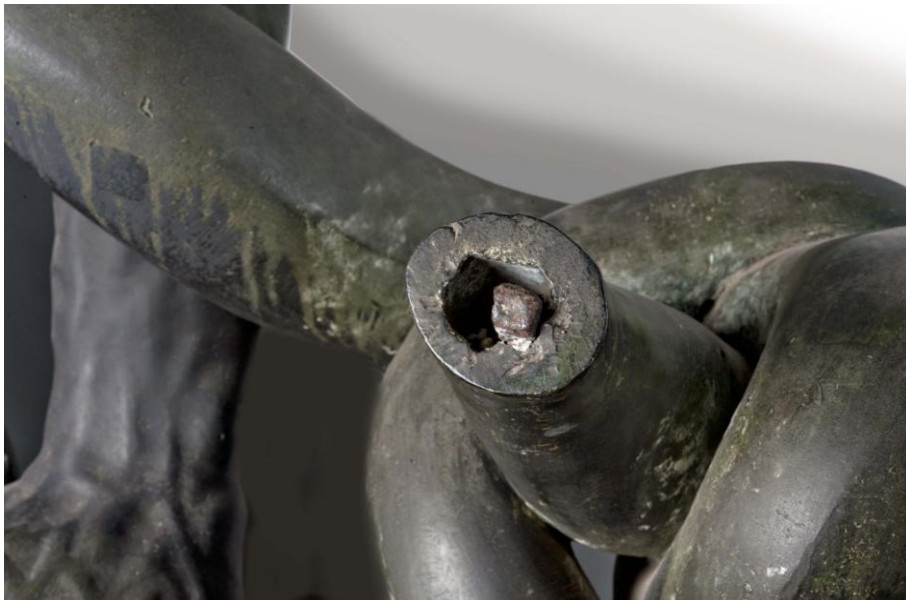
Figure IV 1.1-19 : Laocoon. Armature encore visible dans le bras de droit de l'enfant à la gauche du Laocoon, section carré, 10mm environ. A cet endroit l'épaisseur de la paroi métallique varie de 8 à 10mm. © C2RMF A Maigret
