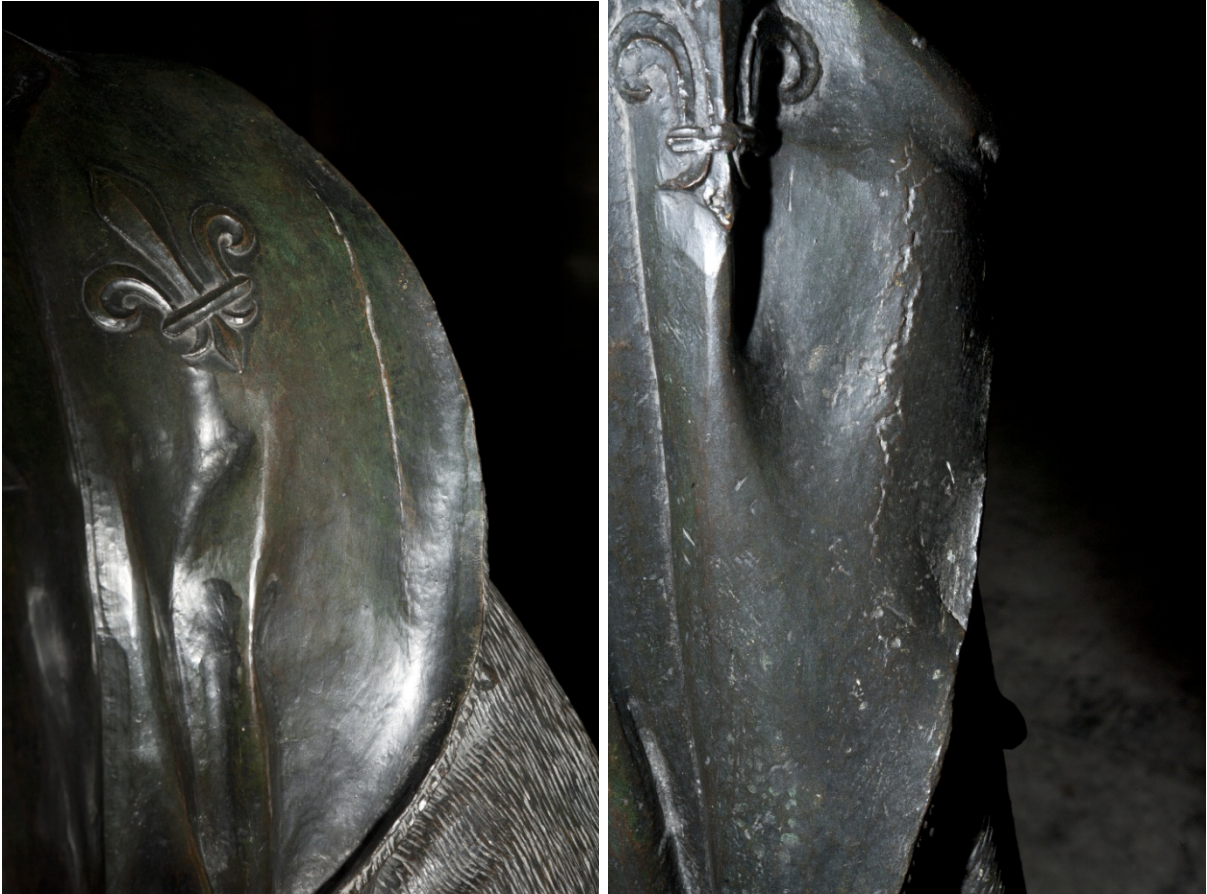
Figure IV 1.2-23 : Henri II ( à gauche ) et Catherine de Médicis ( à droite ) en priant. Détails des zones de coulée secondaire en bordure des draperies © C2RMF A.Maigret
