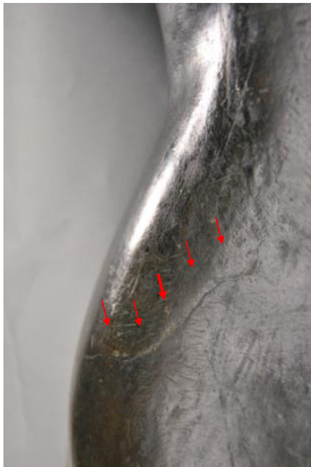
Figure IV 2.2-13 : Vénus Médicis. Détail de la hanche gauche où l'on observe une discontinuité dans la surface du métal, une fissure ? Un déplacement du moule ? © C2RMF M Castelle
