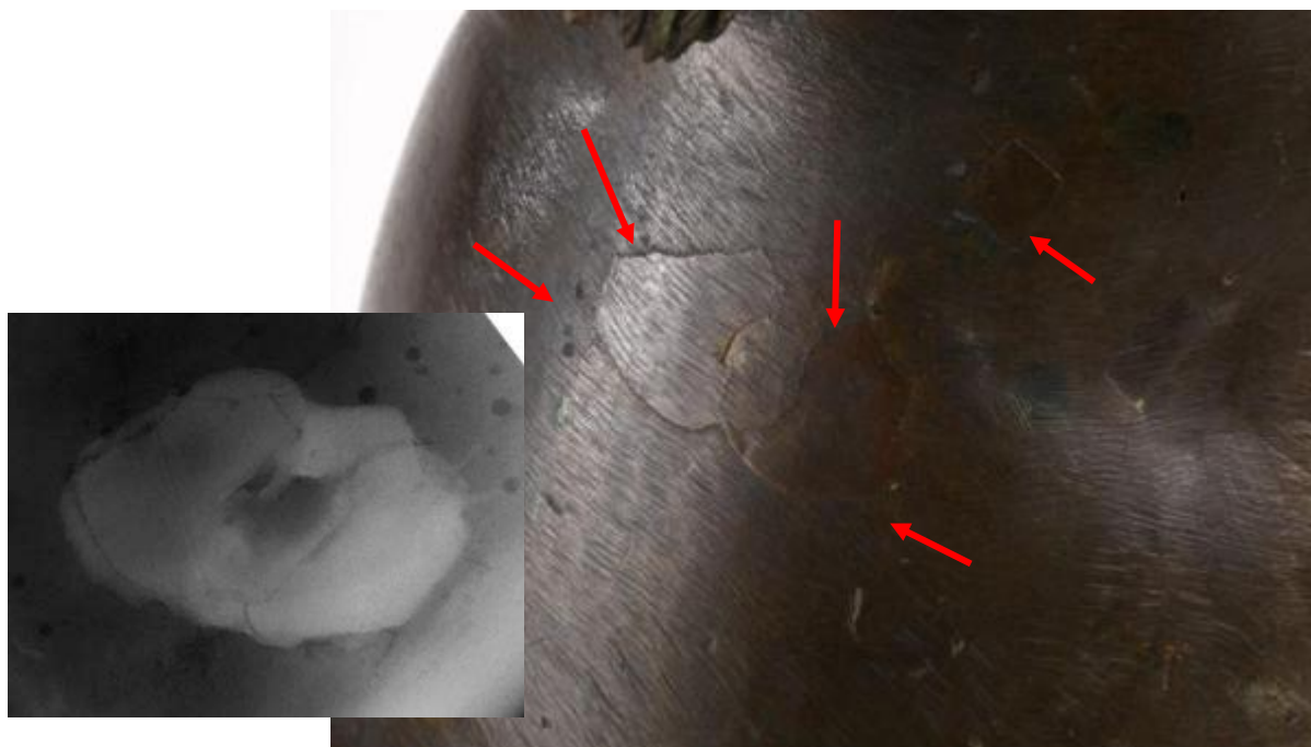
Figure 30 : Spiritello 1, Détail du milieu du dos : une coulée secondaire se détache de la coulée primaire, radiographie correspondante. Des plaquettes quadrangulaires de réparation sont également visibles © C2RMF A Maigret, J Marsca, E Lambert
