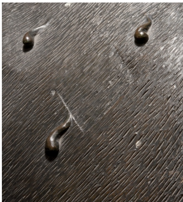
Figure IV 1.2-21 : Henri II en priant. Détail, sur le manteau à l'arrière de la statue, d'une plaquette de réparation (30x30 mm), insérée à froid et ciselée ensuite pour respecter le motif environnant © C2RMF A Maigret
