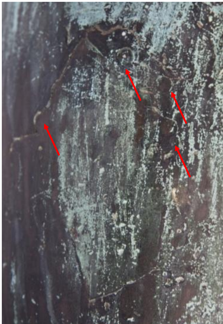
Figure IV 2.2-32 : Apollon du Belvédère. Au centre de l'image, réparation de la cuisse gauche de la statue par coulée secondaire (environ 10 cm de haut) renforcée par des petits rivets (8mm de diamètre) en bordure (flèches rouges). © Musée Bernard d'Agesci, Niort
