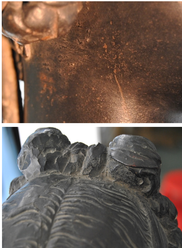
Figure IV 1.3-37 : Justice. En haut : Détail du cou, sous l'oreille droite. La surface du métal a été laissée quasi telle quelle après la fonte, elle n'a pas fait l'objet d'un polissage comme c'est le cas sur d'autres parties de la statue. En bas : Détail du nœud de la coiffure de la Justice. On perçoit nettement les petits « grains » de métal encore présents en surface qui signent un état brut de fonderie. © C2RMF, M Castelle
