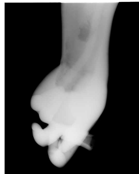
Figure IV 1.2-11 : Prudence. Radiographie \gamma . Détail de la main gauche. La main est pleine jusqu'à la paume. La limite avec la partie remplie de noyau forme un ménisque. Une armature, qui remonte certainement sur toute la hauteur du bras, elle est prise dans la paroi métallique et un fil de fer (1 à 2 mm) de section l'entoure, certainement pour qu'elle reste bien en place, et ne pivote pas, alors qu'on réalise le noyau et l'épreuve en cire. Au niveau du poignet, deux plaquettes de réparures (20x20mm) apparaissent en plus sombre sur la radiographie © C2RMF
