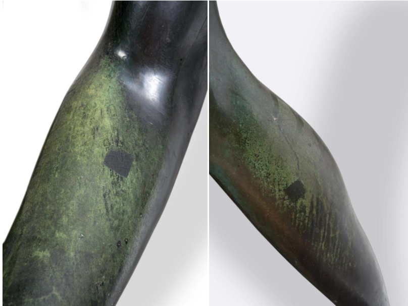
Figure IV 1.1-37 : Apollon. Détails du bras gauche ( à gauche ) et de la jambe gauche ( à droite ) où des plaquettes de réparation (25x25 mm) se détachent nettement de la paroi par leur couleur. © C2RMF A Maigret
