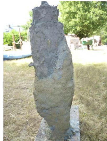
Figure 3 : vue de la chape réfractaire du prototype tubulaire en cours de réalisation (entre les couches 2 et 3)
