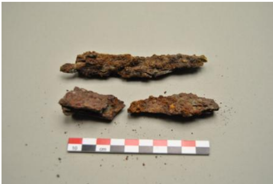
Figure IV 2.2-26 : Apollon du Belvédère. Fragment d'armature trouvé tel quel dans le talon droit de la statue © C2RMF M Castelle
