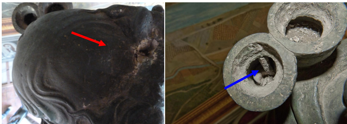
Figure IV 1.1-26 : Apollon. A gauche : Détail de la tête de la statue où ressort l'extrémité d'une armature (section carrée 30x30 mm) (flèches rouges) A droite : Armature encore présente et visible dans le carquois de l'Apollon (flèche rouge), section carrée 20mm. L'épaisseur de la paroi métallique mesurée à cet endroit est de 20mm © C2RMF M.Castelle
