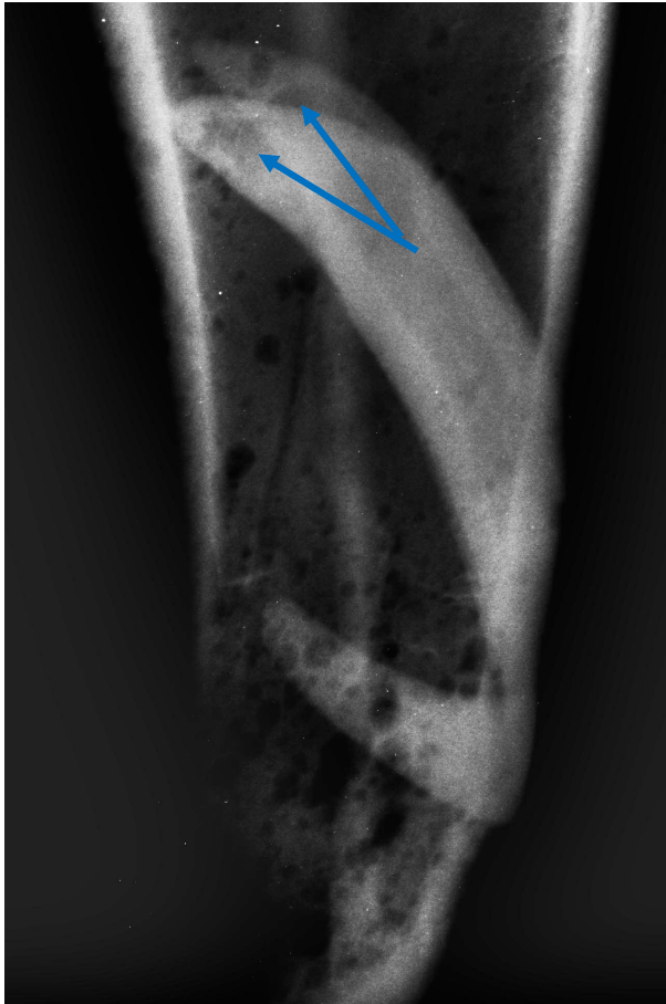
Figure IV 2.1-5 : Diane chasseresse. Radiographie \gamma (filtre passe haut et contraste forcé). Détail de l'avant bras de Diane et des bois du cerf. Ces derniers sont creux jusqu'à leur extrémité. La porosité apparaît importante à mesure que l'on se rapproche de la main de Diane © C2RMF
