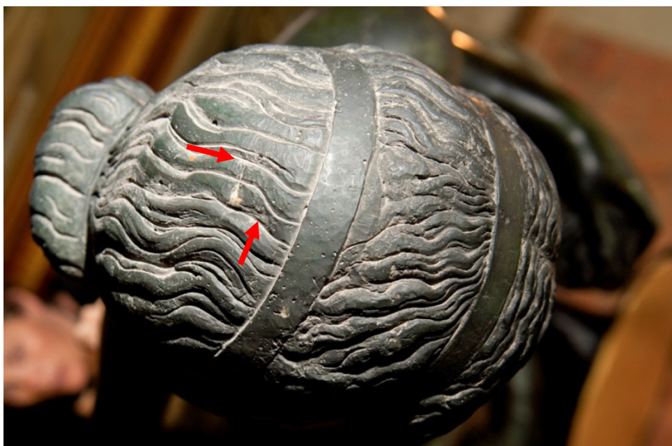
Figure IV 1.1-33 : Vénus. Détail de la tête, où une pièce de réparation (30x30 mm), ciselée, se confond dans la chevelure et masque l'extrémité de l'armature centrale. Entre les deux bandeaux, une coulée secondaire de réparation a certainement été réalisée en guise de réparation, comme en témoigne l'aspect de surface légèrement différents du reste de la tête © C2RMF A.Maigret
