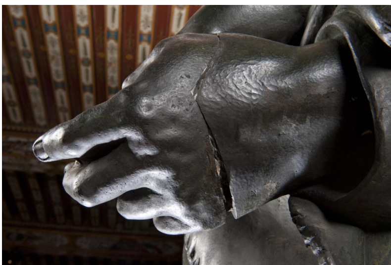
Figure IV 1.1-8 : Hercule. Détail de l'assemblage « bords à bords » de la main gauche et du pied de l'enfant, en haut vue de dessus et en bas vue du dos de la main. © C2RMF A Maigret
