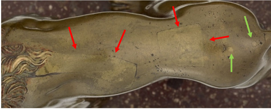
Figure 43 : Lion marchant. Vue du dos du Lion : mise en évidence des deux principaux types de pièces de réparation (flèches rouges pour les plaques et vertes pour les cercles, désignation non exhaustive) Remarquer aussi la porosité du métal, visible depuis la surface (©C2RMF, A Maigret
