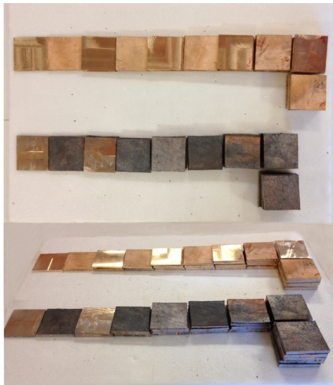
Figure III 2.3-21 : photographies de l'échelle métallique en haut de chaque image l'alliage \text{Cu}_4\text{Sn}_6\text{Zn}_1\text{Pb} , en bas l'alliage \text{Cu}_4\text{Sn}_6\text{Zn}_{30}\text{Pb} , chaque carré fait 4,5\text{cm} de côté © C2RMF M Castelle
