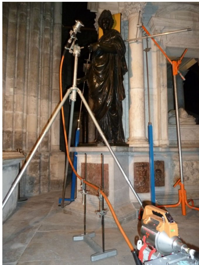
Figure III 2.3-20 : Vue du dispositif expérimental lors de la réalisation de radiographie \gamma in situ sur la Prudence du monument funéraire d'Henri II et de Catherine de Médicis à la Basilique Saint Denis
