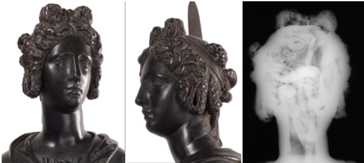
Figure IV 1.3-22 : Justice. Tête de la statue vue de face ( à gauche ), de profil ( au milieu ) et de face en radiographie X ( à droite ) © C2RMF A Maigret, J Marsac, E Lambert
