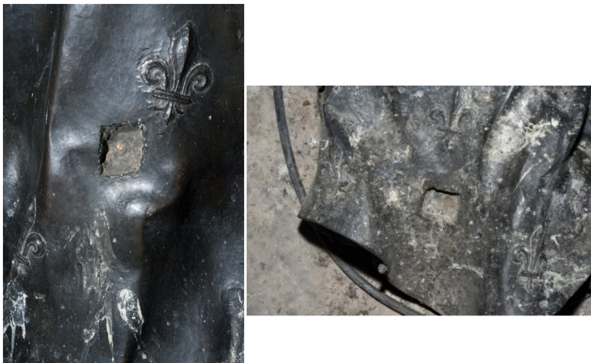
Figure IV 1.2-14 : Catherine de Médicis en priant. Détail du manteau présentant des manches de forme carrée ne traversant pas la paroi métallique (3x3cm) © C2RMF A Maigret
