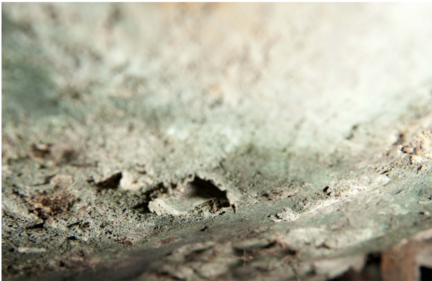
Figure III 2.3-9 : Primatice (maître d'œuvre), Laocoon, MR 3290, 1542, Château de Fontainebleau. Détail de la paroi interne, une plaquette de réparation est visible et en bordure, de fines bavures qui dépassent de quelques millimètres © C2RMF A Maigret
