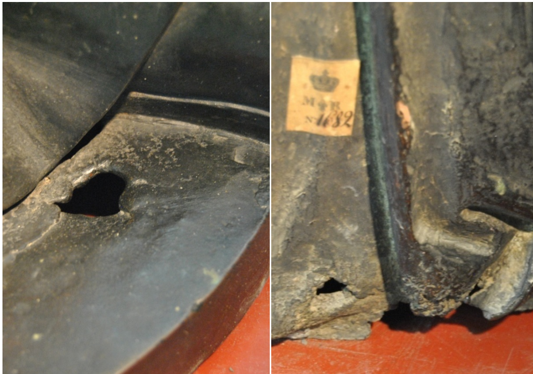
Figure IV 1.3-32 : Justice. En haut : Détail du socle où une petite partie est mal venue lors de la fonte. En bas : Détail d'une zone au bas de la draperie, où le métal n'est pas parvenu jusqu'au bout du moule : la frontière du métal est irrégulière et rompt le modelé du drapé. © C2RMF, M Castelle
