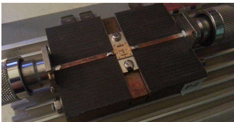
Fig II-20 : Démonstrateur de puissance (10 W, 2.9 GHz) connectorisé 50 \Omega pour la mesure de stabilité pulse à pulse
