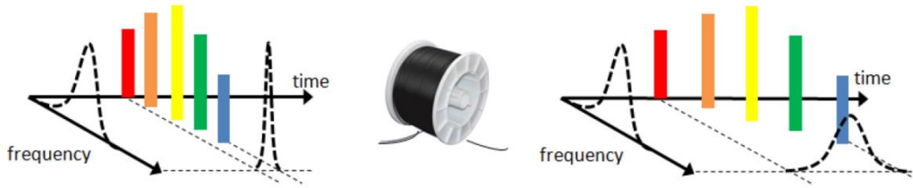
Figure 2.5 : Illustration de l'effet de la dispersion chromatique sur un signal impulsionnel.
