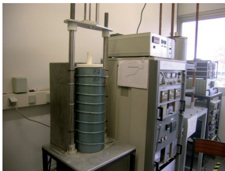
Figure III-18 : image du four Bridgman utilisé pour la croissance.
