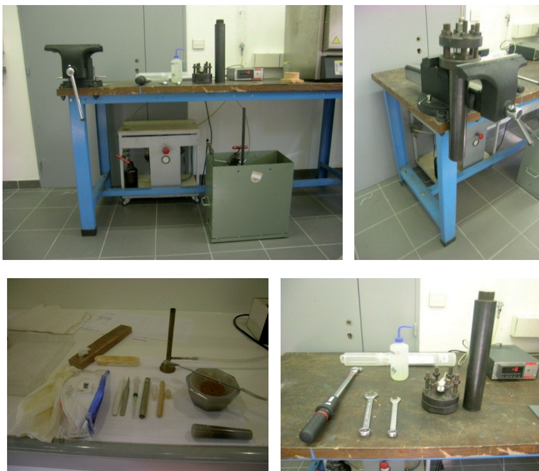
Figure III-2 : l'appareillage de haute pression et outils utilisés pour la préparation des barreaux.
