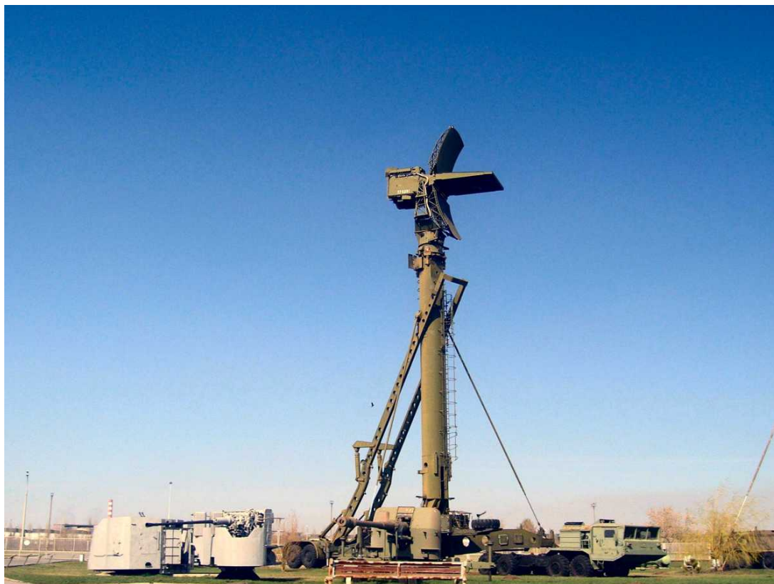
Fig. I.14 – Radar FMCW : Radar d'acquisition basse altitude 76N6
