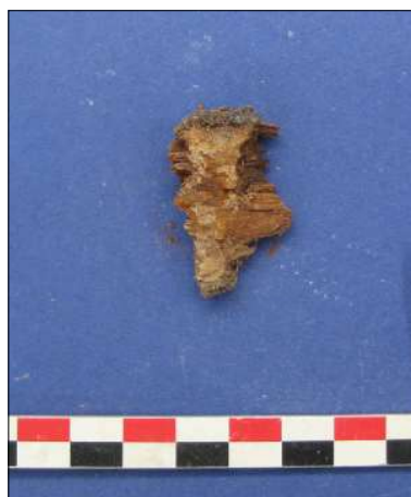
Figure 135 : exemple d'un clou portant des fragments de bois perminalisé
