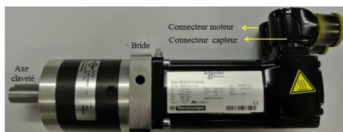
Figure 101 : Servomotoréducteur BSH0551P31A2A
